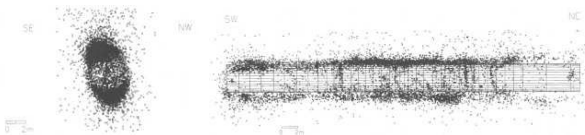
Figure 7.4 – Localisation des événements micro-sismiques enregistrés au cours du Mine-By-Test (ASL)
