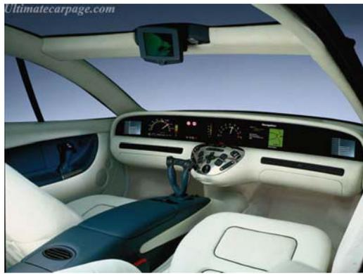
Ce concept car de Mercedes-Benz illustre la recherche sur le remplacement des commandes traditionnelles (volant, levier de vitesse...) par un système de commandes électriques de type joystick.
