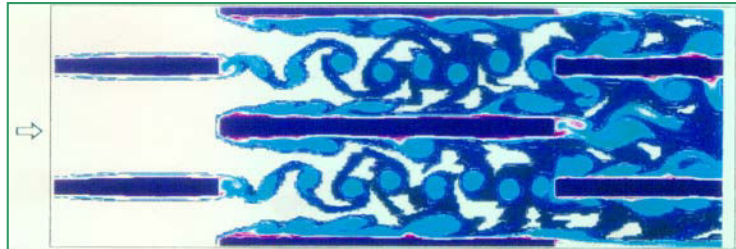
Figure I.8 - Carte instantanée des isothermes en entrée d'échangeur (onde serrated).
