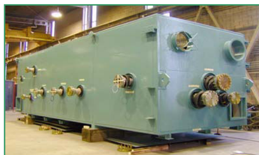
Figure I.24 - Boîte froide vue extérieure
