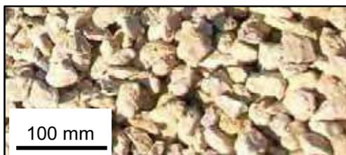
Figure II 14 - Calcaire à polypiers concassé.
