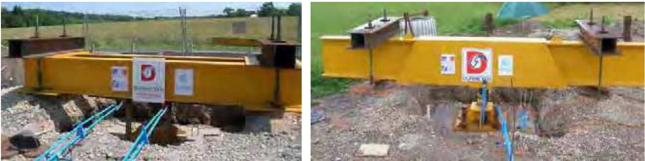
Figure II 28 - Essai de chargement de la semelle sur le sol naturel (gauche) et sur la colonne (droite).
