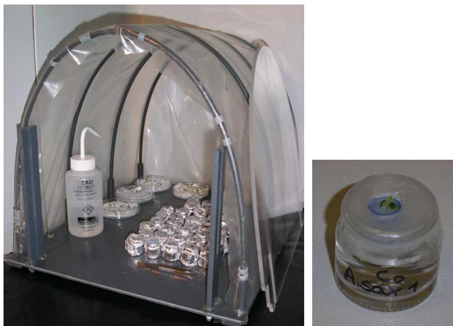
Photographie 7. Dispositif de culture en milieu hydroponique.
