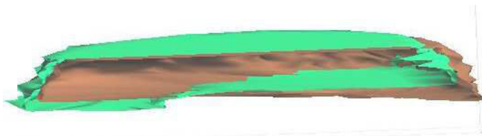
Figure 166: coupe des surfaces fermées issus de sonar des puits SG4 et SG5: les surfaces s'intersectent.
