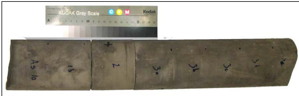
Figure 83: tronçon d'argilite silteuse prélevé pour l'expérimentation batch. Les variations de teinte ne sont que superficielles et proviennent probablement d'un artefact du sondage (boue, humidité...).
