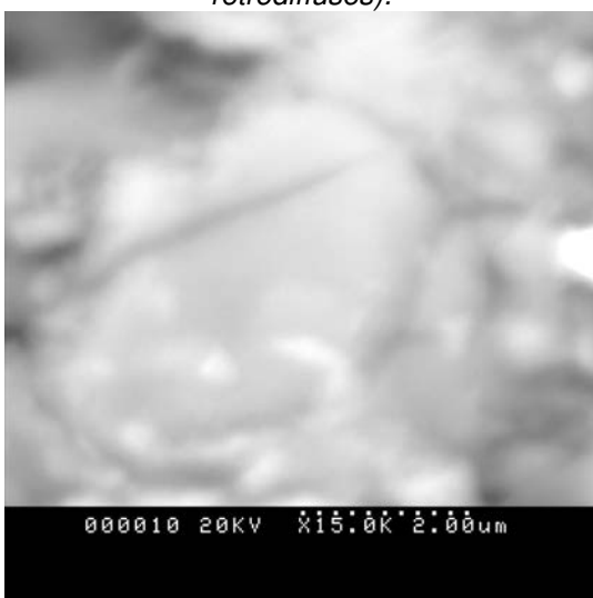
Figure 45 : mise en évidence de magnésite au sein de l'anhydrite microgrenue par imagerie en électrons rétrodiffusés couplée à une analyse semi-quantitative.
