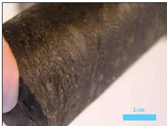
Figure 130: néoformation halitique en surface de l'éprouvette 1 (photo prise après essai, avant séchage)
