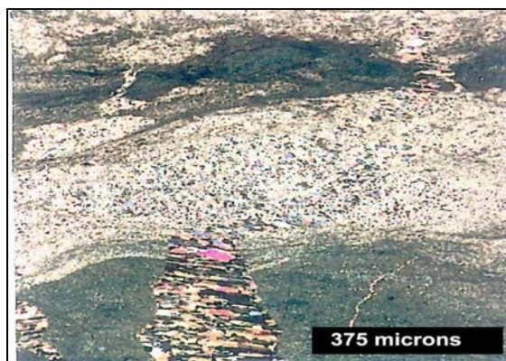
Figure 38: fissure à remplissage anhydritique tabulaire (lumière polarisée analysée).
