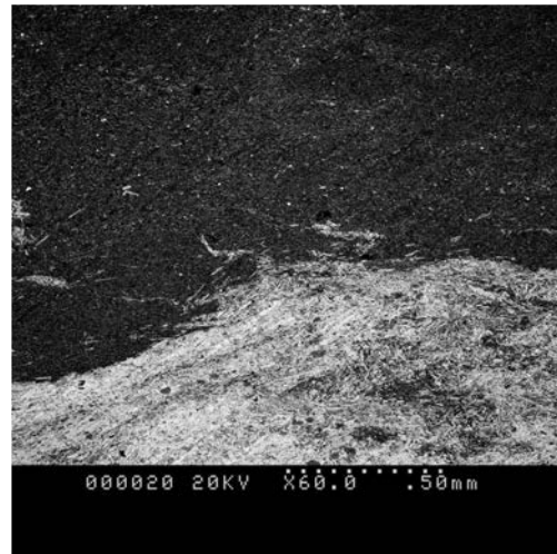
Figure 51: contact net entre nodule d'anhydrite microprismatique et matrice argileuse (imagerie en électrons rétrodiffusés).
