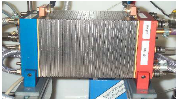
Figure 3.4 : Stack de la pile ZSW, 500W, 23 cellules.
