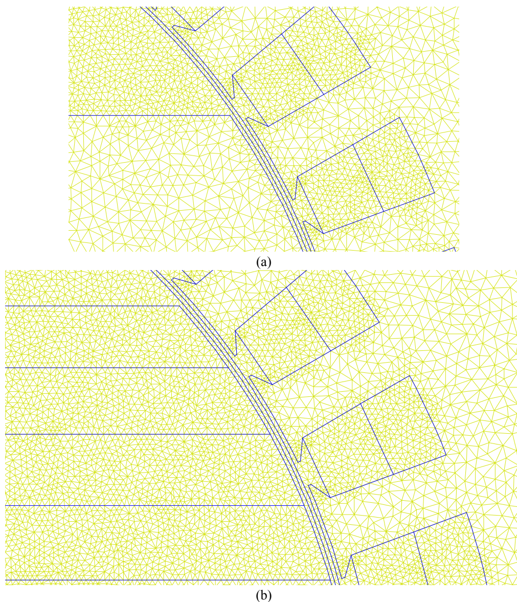
Fig. 2.2 Maillage : a – machine à rotor massif, b – machine à rotor avec barrières de flux.
