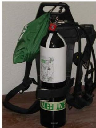
Figure 6.3-4 Photographie du système de respiration autonome
