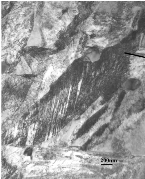
Photographie 3.20. Microstructure en surface de l'acier 15NiMoCr10 après traitement de cémentation suivi du revenu à 300°C-100h (*macles dans les plaquettes de la phase martensitique*) ; champ clair x22000
