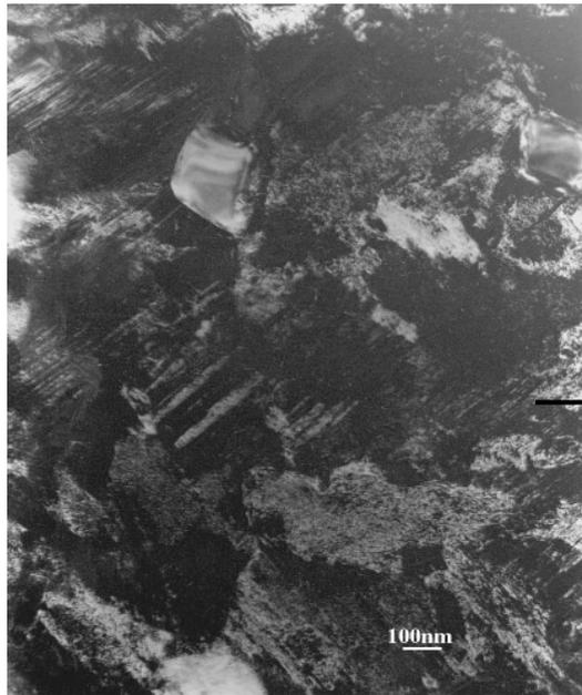
Photographie 3.12. Microstructure en surface de l'acier 15NiMoCr10 après traitement de cémentation suivi de la trempe à 25°C (*phase martensitique en plaquettes*) ; champ clair x35000
