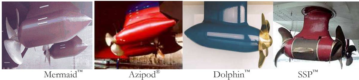
Figure 1.3 : Différentes technologies de propulsion POD existantes sur le marché
