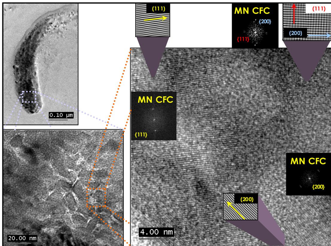
Figure II-60 : Réplique d'extraction de T3 après nitruration N6, effectuée à 50 $\mu$ m de la surface, observée au METHR - Nitrures globulaires, agrandissements successifs : images de haute résolution, transformées de Fourier et images filtrées révélant l'incohérence des nitrures (orientation aléatoire des plans).
