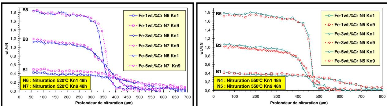
Figure II-1 (g) : Profils N des alliages binaires B1, B3 et B5, nitrurés à 520°C avec un Kn de 1 (N6) et 9 (N7) - g - ; à 550°C avec un Kn de 1 (N4) et 9 (N5) - d -.
