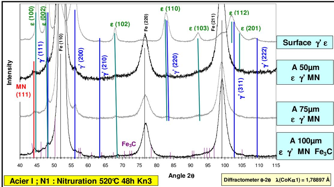
Figure III-36 : Spectres de rayons X, effectués avec un diffractomètre  $\theta$ - $2\theta$  sur l'acier I nituré (N1'), à la surface puis à 50, 75 et 100 $\mu$ m de la surface. Confirmation de la présence de nitrures de fer ( $\epsilon$  et  $\gamma'$ ) jusqu'à 100 $\mu$ m (détectable).
