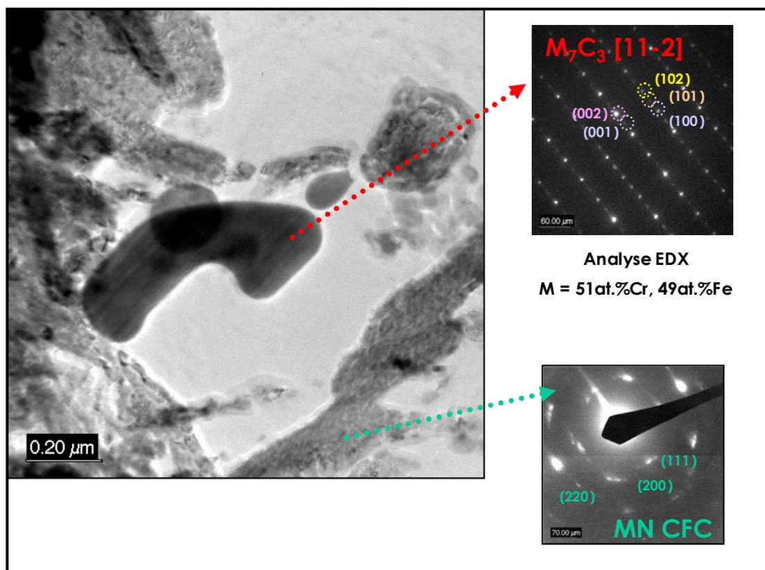
Figure II-64 : Réplique d'extraction de T3 après diffusion d'azote  $N_6D_3$ , effectuée à  $50\mu m$  de la surface, observée au METHR - L'image de haute résolution avec le cliché de diffraction sur un précipité d'apparence lisse témoigne que ce carbure, présentant la structure  $M_7C_3$  ne s'est pas transformé en nitrures. Les autres carbures entourant ce dernier sont totalement transformés en nitrures MN CFC (cliché de diffraction à l'appui).
