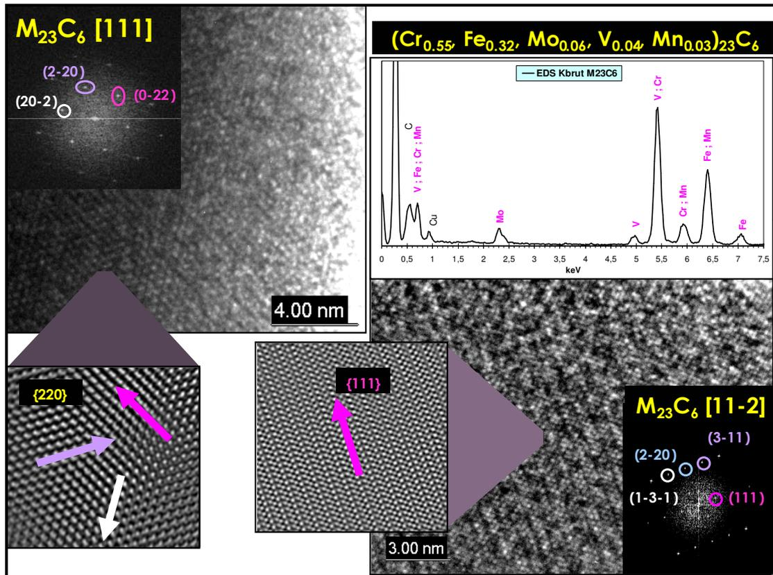
Figure III-6 : Réplique extractive de carbures, réalisée dans l'acier K brut, observée au METHR - Carbures  $M_{23}C_6$  : images de haute résolution, transformées de Fourier, images filtrées (transformées de Fourier inverses) et spectre EDX.
