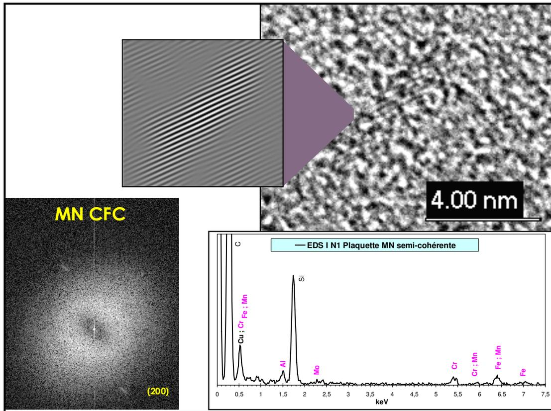
Figure III-32 : Réplique extractive, réalisée dans l'acier I nitruré (N1') à 50μm de la surface, observée au METHR - Plaquette MN CFC : image de haute résolution, transformée de Fourier, image filtrée et spectre EDX.
