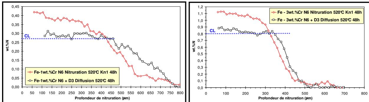
Figure II-18 : Profils N de B1 (g) et B3 (d) après nitruration à 520°C (N6) et après diffusion à 520°C (D3).
