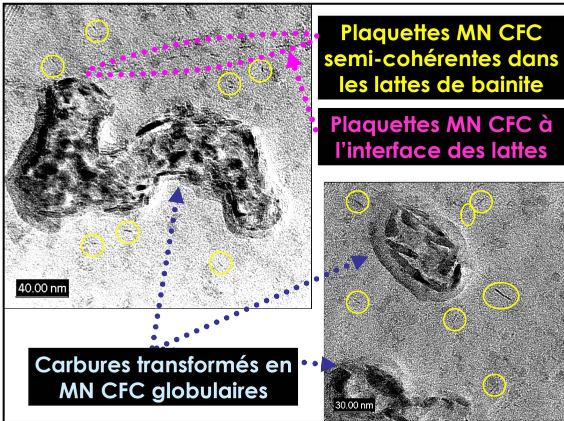
Figure III-30 : Réplique extractive, réalisée dans l'acier I nitruré (N1') à 50 $\mu$ m de la surface, observée au METHR - Nitrures MN CFC : plaquettes semi-cohérentes et nitrures globulaires incohérents.
