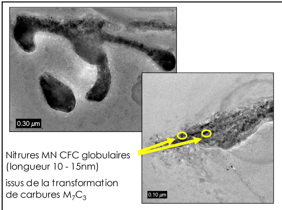
Figure II-59 : Réplique d'extraction de T3 après nitruration N6, effectuée à 50 $\mu$ m de la surface, observée au METHR - Vue générale des précipités globulaires issus de la transformation des carbures.
