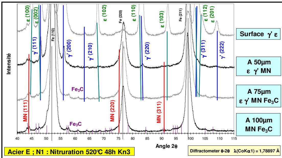
Figure III-37 : Spectres de rayons X, effectués avec un diffractomètre  $\theta$ - $2\theta$  sur l'acier E nituré (N1'), à la surface puis à 50, 75 et 100 $\mu$ m de la surface. Confirmation de la présence de nitrures de fer ( $\epsilon$  et  $\gamma'$ ) jusqu'à 75 $\mu$ m (détectable).
