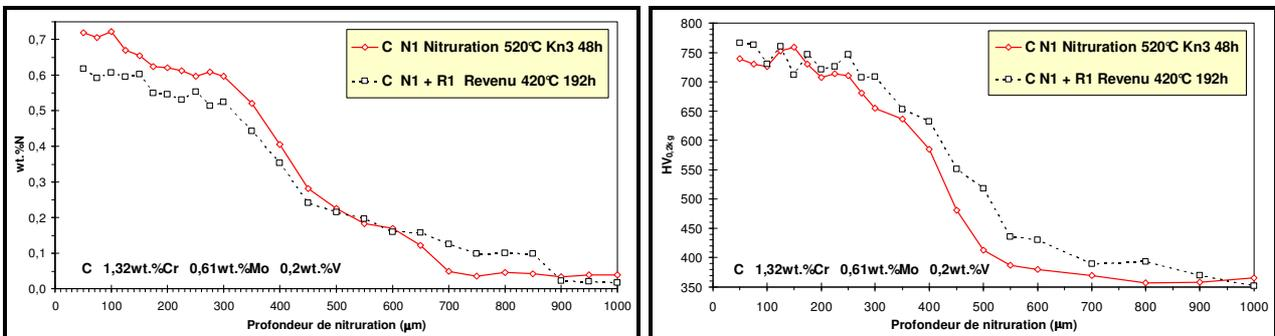
Figure I-30 : Profils N et  $\Delta HV_{0,2kg}$  de l'acier C après nitruration N1, puis revenu R1 (420°C 192h).
