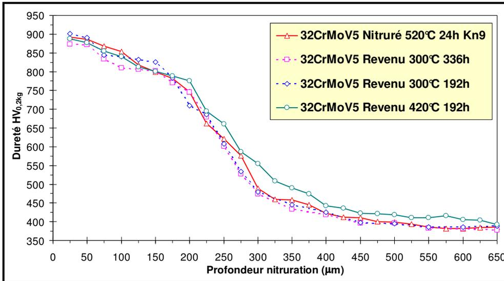
Figure I-29 : Profils  $\Delta HV_{0,2kg}$  de l'acier E (1,3%Cr 0,2%Al) après nitruration N1, suivie d'un revenu à 300°C pendant 192h et 336h, et d'un revenu à 420°C pendant 192h.
