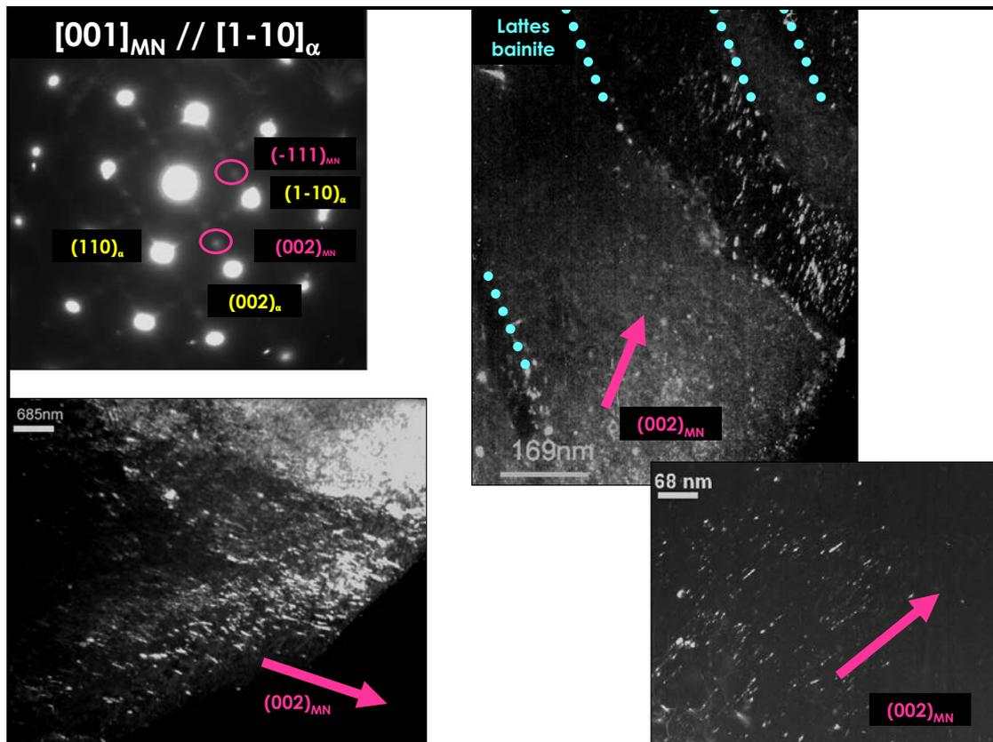
Figure III-31 : Lamelle mince, réalisée dans l'acier I nitruré (N1') à 50 $\mu$ m de la surface, observée au METHR - Semi-cohérence des plaquettes à l'intérieur de lattes de bainite : cliché de diffraction, images en champ sombre  $(002)_{CrN}$ .
