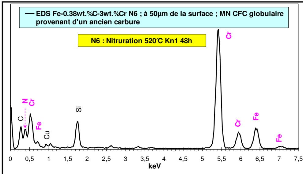
Figure II-61 : Réplique d'extraction de T3 après nitruration N6, effectuée à 50µm de la surface - L'analyse EDX sur les nitrures globulaires, issus de la transformation des carbures  $M_7C_3$ , atteste de la présence de fer ( $Cr_xFe_y$ )N CFC.
