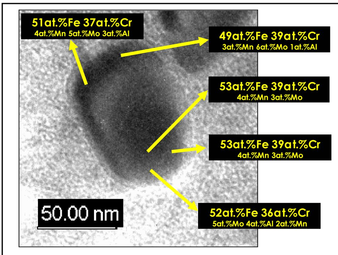
Figure III-13 : Réplique extractive, réalisée dans l'acier I brut, observée au METHR – Analyses EDX effectuées sur le même carbure.
