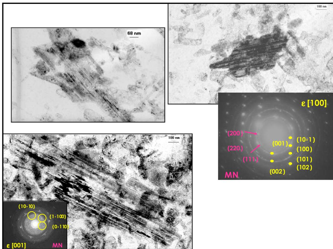
Figure III-35 : Réplique extractive, réalisée dans l'acier I nitruré (N1') à 50 $\mu$ m de la surface, observée au METHR - Nitrures de fer  $Fe_{2.3}N$  : images de haute résolution et transformées de Fourier.
