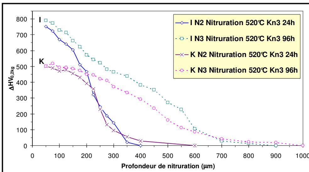
Figure I-42 : Profils  $\Delta HV_{0,2kg}$  des aciers I (1,73%Cr 0,94%Al) et K (3%Cr), nitrurés pendant 24h (N2) et 96h (N3).
