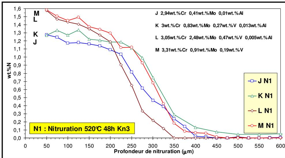
Figure I-24 : Profils N des aciers industriels nitrurés (N1), contenant environ 3%Cr : J, K, L et M.
