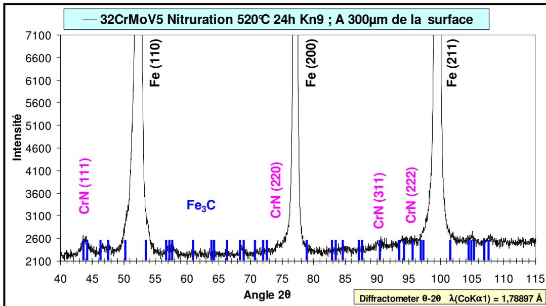
Figure I-14 : Spectre de diffraction de rayons X, réalisé à 300µm de la surface de l'acier 32CrMoV5 nitruré à 520°C pendant 24h avec un Kn de 9.
