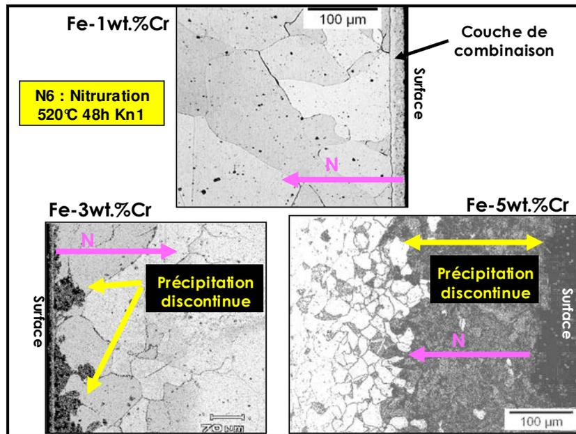
Figure II-6 : Micrographies optiques des alliages binaires B1, B3 et B5, nitrurés à 520°C pendant 48h avec un Kn de 1 (N6).
