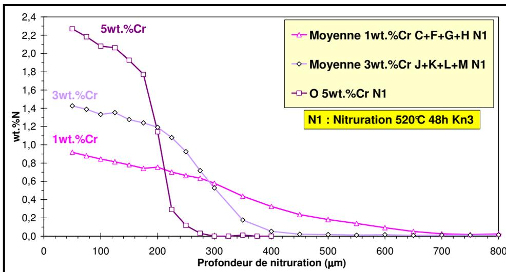
Figure I-20 : Profils N des aciers industriels niturés (N1).
