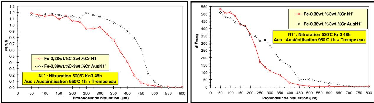
Figure II-10 : Profils N (g) et  $\Delta HV$  (d) en fonction de la profondeur de nitruration de T3 nitruré (N1').
