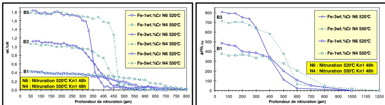
Figure II-4 : Profils N (g) et  $\Delta$ HV<sub>0,1kg</sub> (d) de B1, B3 et B5 nitrurés pendant 48h à 520°C (N6) et à 550°C (N4).
