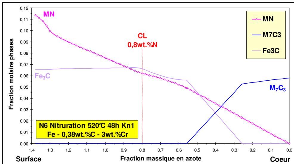
Figure II-27 : Calculs thermodynamiques par Thermo-Calc de la fraction molaire des phases en fonction de la fraction massique en azote (valeur maximale correspondant à celle déterminée expérimentalement à 50 $\mu$ m de la surface) de l'alliage T3, nitruré (N6).
