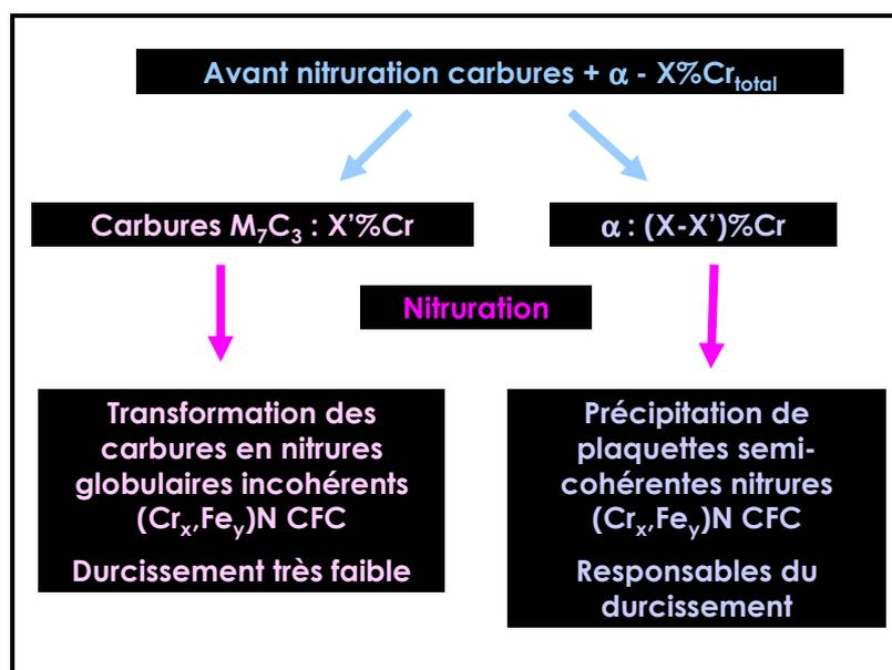
Figure II-70 : Schéma représentant les mécanismes de précipitation et de durcissement dans les alliages ternaires.
