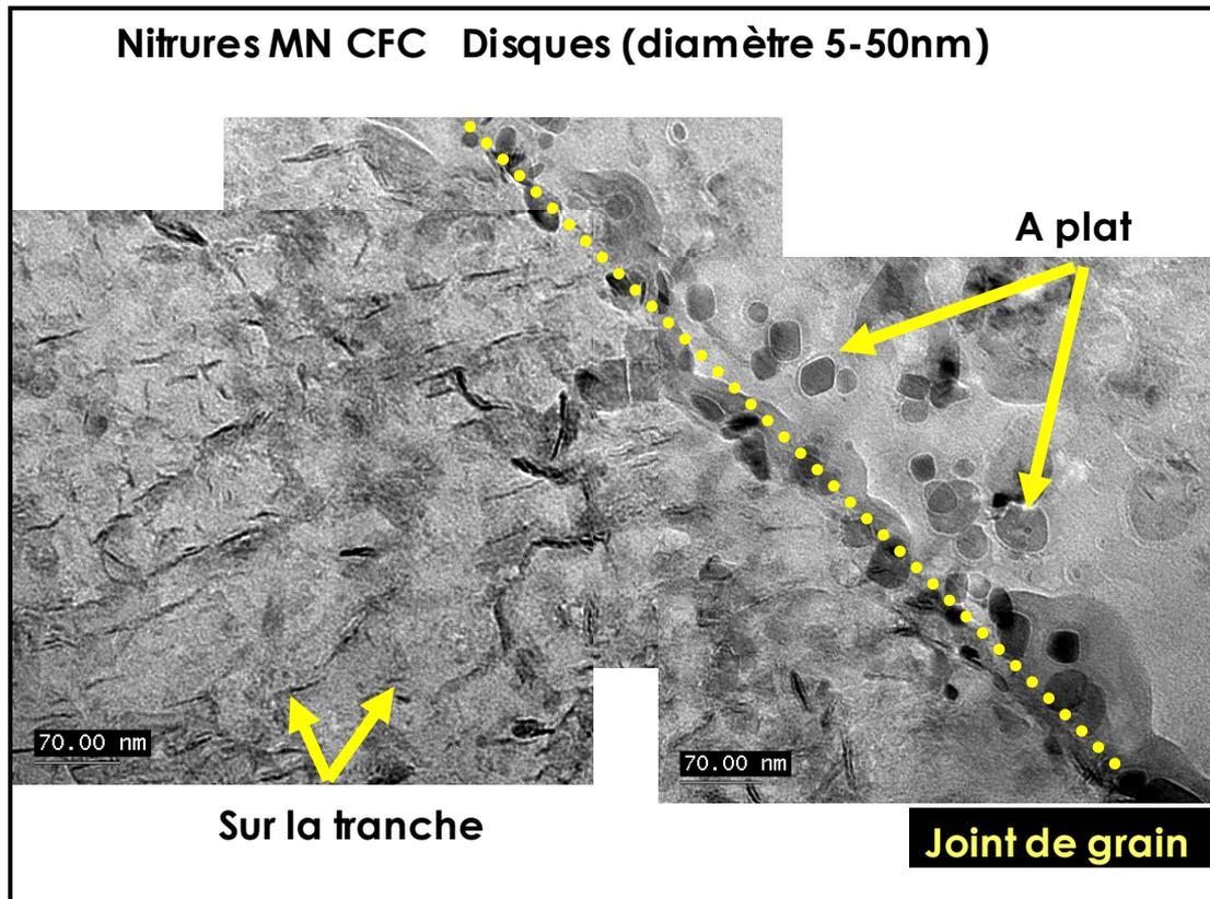
Figure II-39 : Réplique d'extraction de B3 nitruré (N6), effectuée à 400 $\mu$ m de la surface, observée au METHR - Vue générale de précipités (disques). De part et d'autre du joint de grain, les précipités ont été recueillis sur la tranche (à gauche) et à plat (à droite), les grains ne présentant pas la même orientation.
