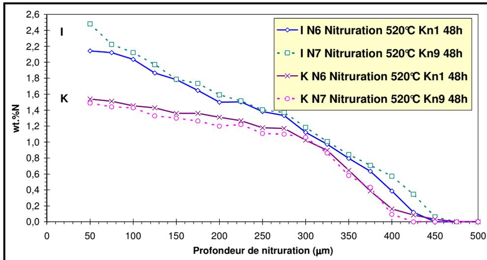
Figure I-45 : Profils N des aciers I (1,73%Cr 0,94%Al) et K (3%Cr), nitrurés avec un Kn de 1 (N6) et de 9 (N7).
