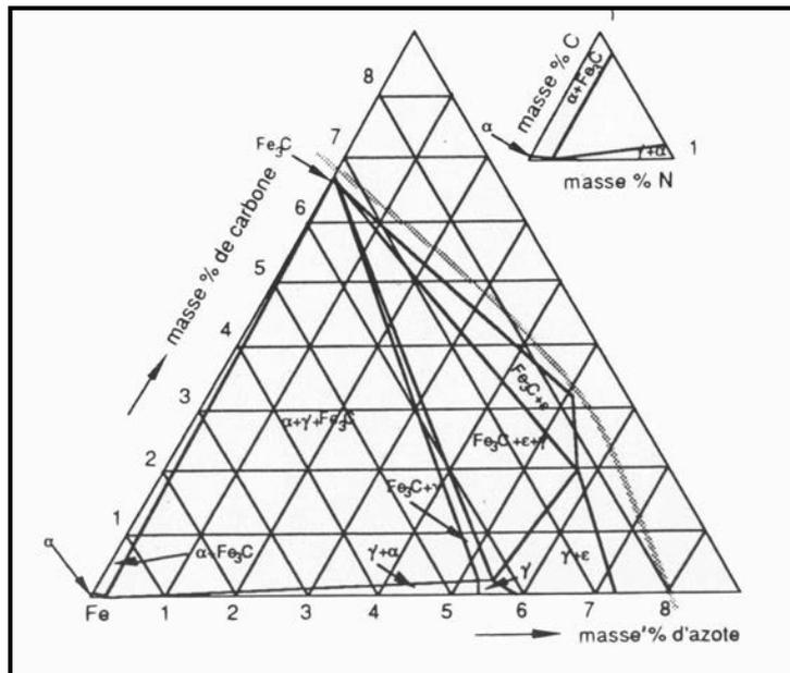
Figure I-5 : Diagramme Fer-Carbone-Azote à 570°C [87RAG].
