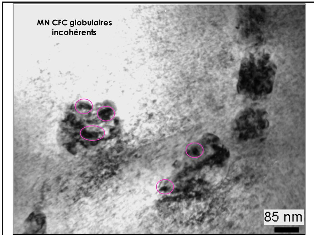
Figure II-62 : Lame mince provenant de T3 nitruré (N6), prélevée à 50 $\mu$ m de la surface, observée au METC - Images en champ clair de quelques carbures transformés en nitrures globulaires, avec des clichés de diffraction correspondants, révélant l'incohérence des nitrures.
