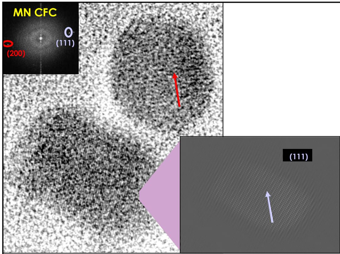
Figure II-45 : Réplique d'extraction de B3 nitruré puis diffusion d'azote (N6D3), effectuée à 50 $\mu$ m de la surface, observée au METHR - Nitrures MN CFC : images de haute résolution, transformées de Fourier et images filtrées.
