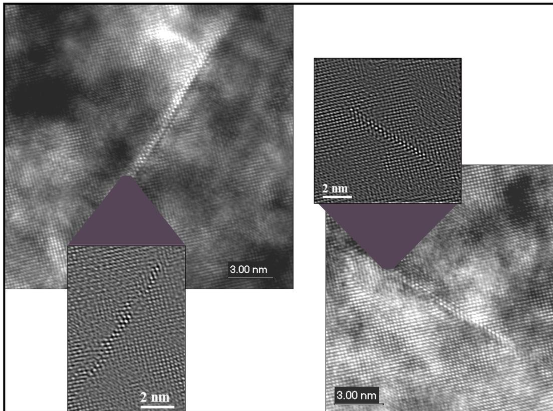
Figure II-53 : Lame mince provenant de T3 nitruré (N6), prélevée à 50 $\mu$ m de la surface, observée au METHR - Plaquettes MN CFC semi-cohérentes : images de haute résolution, transformées de Fourier et images filtrées révélant une épaisseur de quelques plans atomiques seulement.
