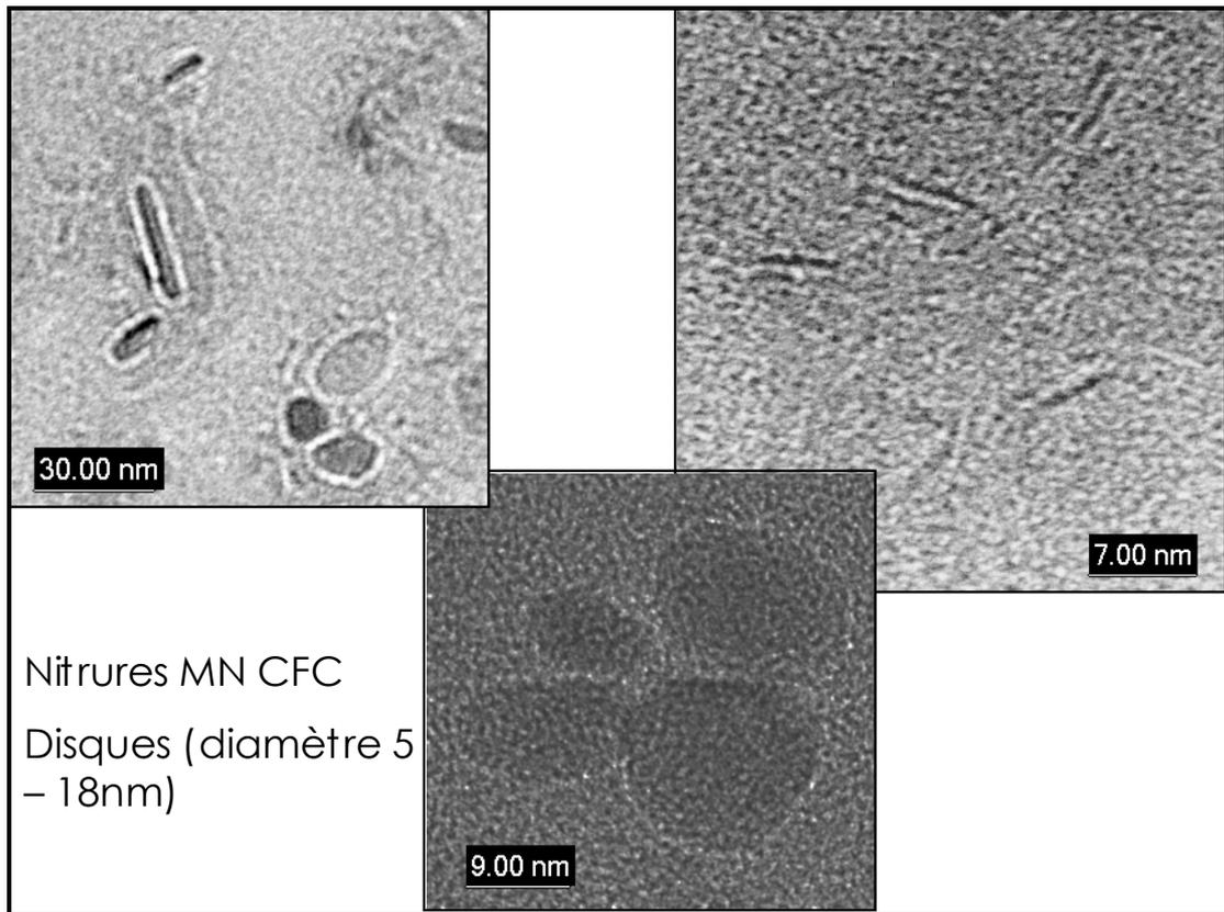
Figure II-56 : Réplique d'extraction T3 après diffusion d'azote N6D3, effectuée à 50µm de la surface, observée au METHR - Vue générale des précipités.
