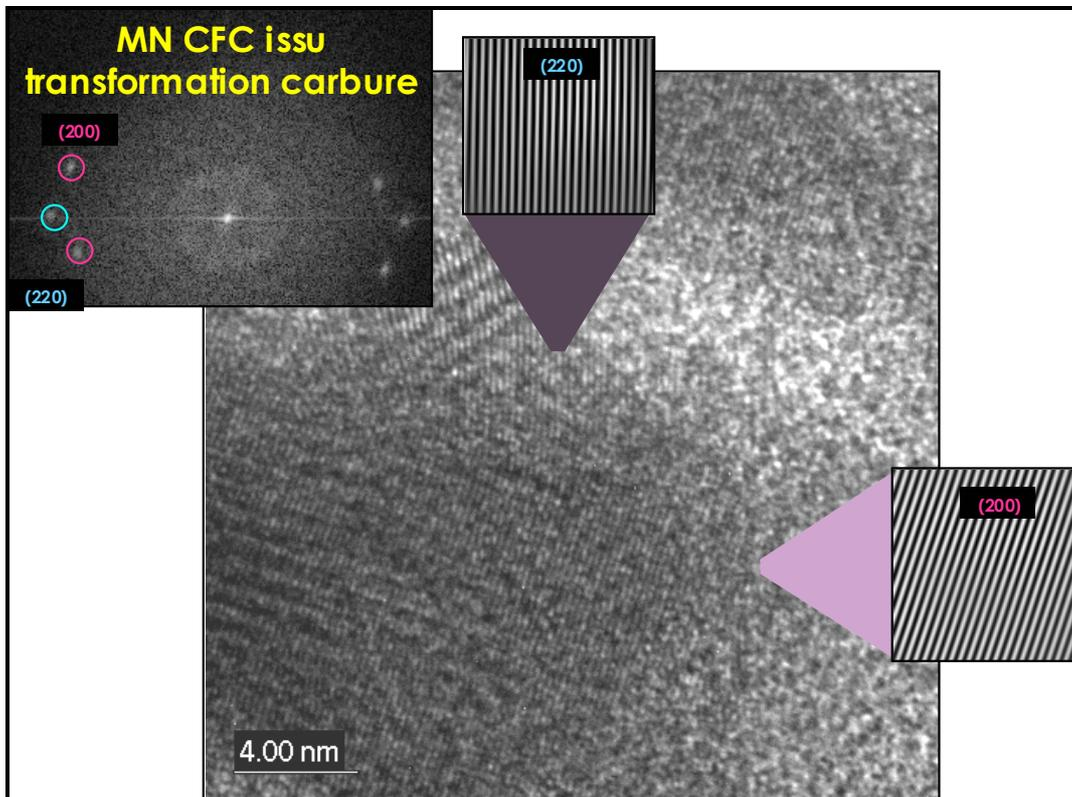
Figure III-26 : Réplique extractive, réalisée dans l'acier I nitruré (N1) à 50 $\mu$ m de la surface, observée au METHR - Nitrures globulaires MN CFC, issus de la transformation des carbures : image de haute résolution, transformée de Fourier et images filtrées.
