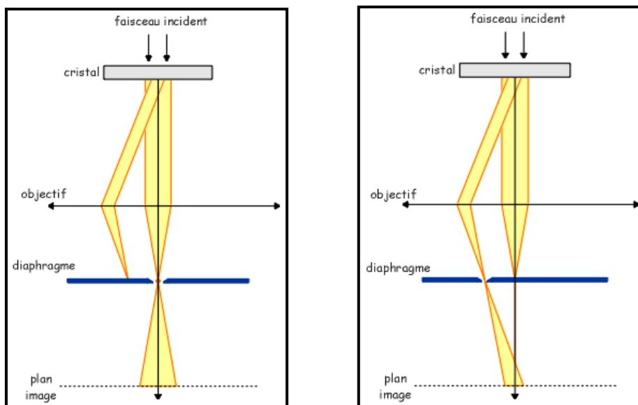
Schémas représentant les faisceaux transmis et diffractés. A gauche, seul le faisceau transmis arrive jusqu'au plan image, le faisceau diffracté est bloqué par le diaphragme de contraste, afin de former une image en champ clair. A droite, seul un faisceau diffracté par une famille de plans atteint le plan image, pour former une image en champ sombre.
