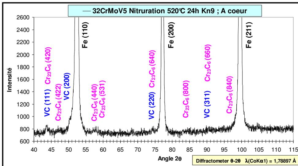
Figure I-12 : Spectre de diffraction de rayons X, réalisé à coeur de l'acier 32CrMoV5 nitruré à 520°C pendant 24 h avec un Kn de 9.
