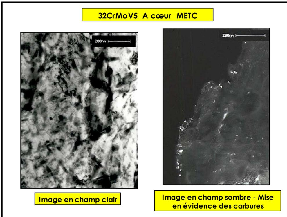
Figure I-13 : Images réalisées au METC à partir d'une lame mince prélevée à cœur de l'acier 32CrMoV5 nitruré à 520°C pendant 24h avec un Kn de 9.
