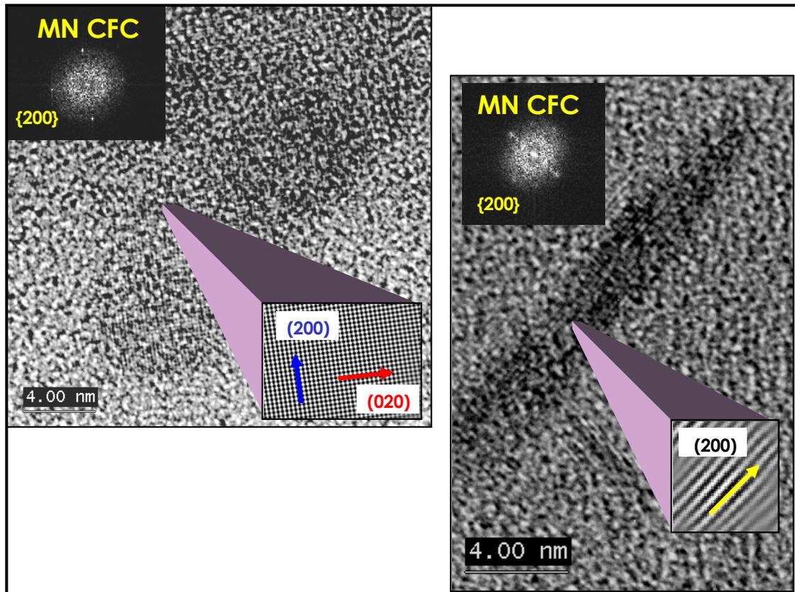
Figure II-29 : Réplique d'extraction de B1 nitruré (N6), effectuée à 50 $\mu$ m de la surface, observée au METHR - Nitrures MN CFC : images de haute résolution, transformées de Fourier et images filtrées, obtenues par transformée de Fourier inverse après sélection des taches correspondant à la famille de plans {200} du CrN.
