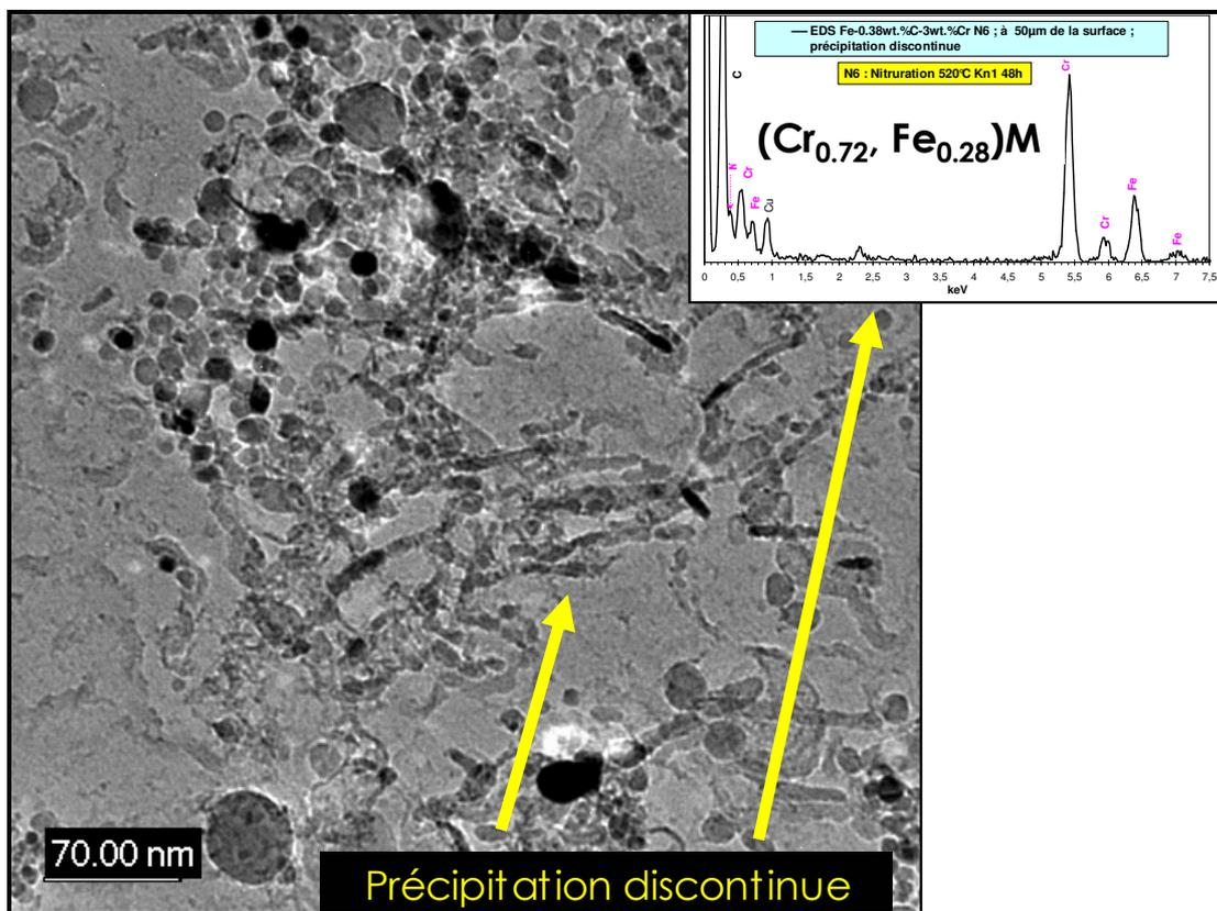
Figure II-54 : Réplique d'extraction de T3 nitruré (N6), effectuée à 50 $\mu$ m de la surface, observée au METHR - Présence de précipitation homogène et discontinue, spectre EDX relatif à la précipitation discontinue.
