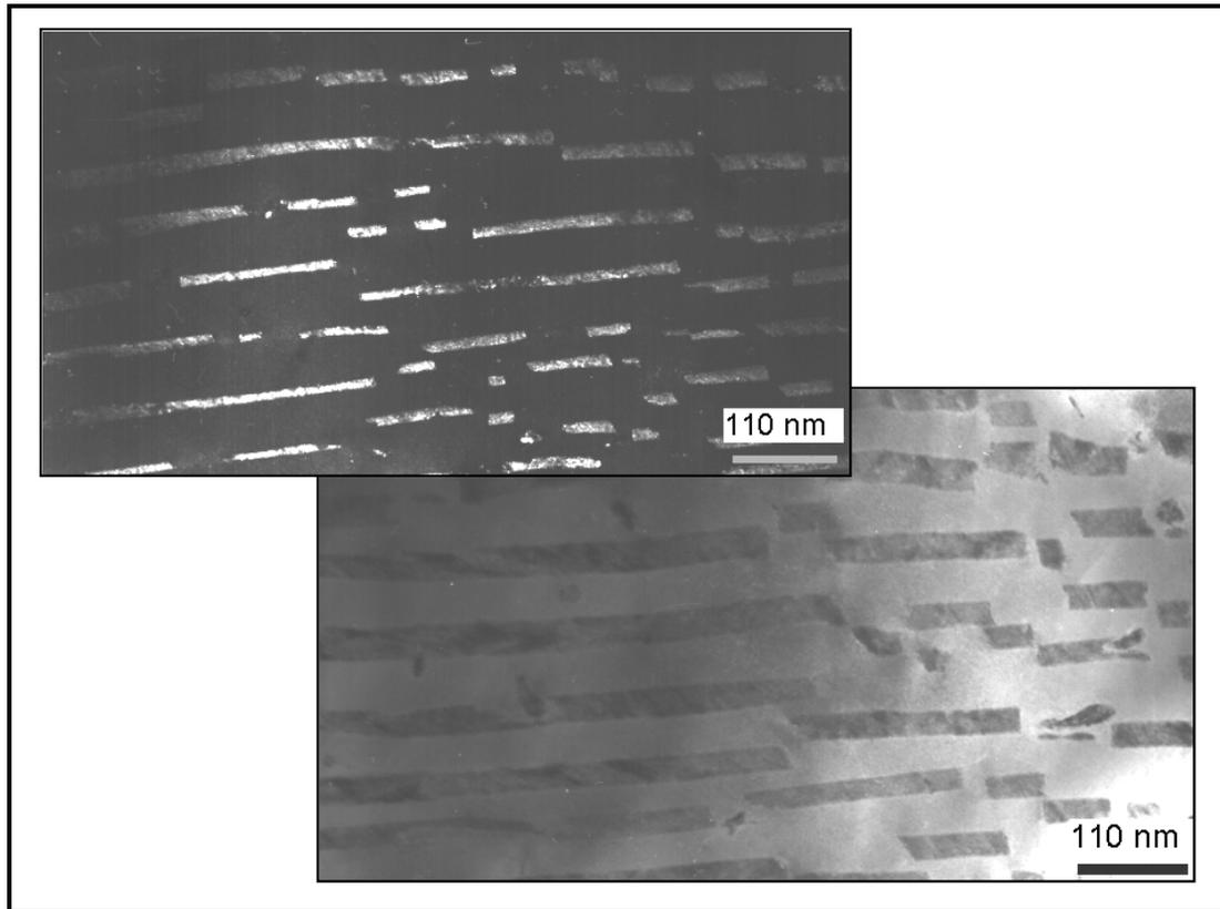
Figure II-55 : Lame mince provenant de T3 nitruré (N6), prélevée à 50 $\mu$ m de la surface, observée au METC - Perlite.
