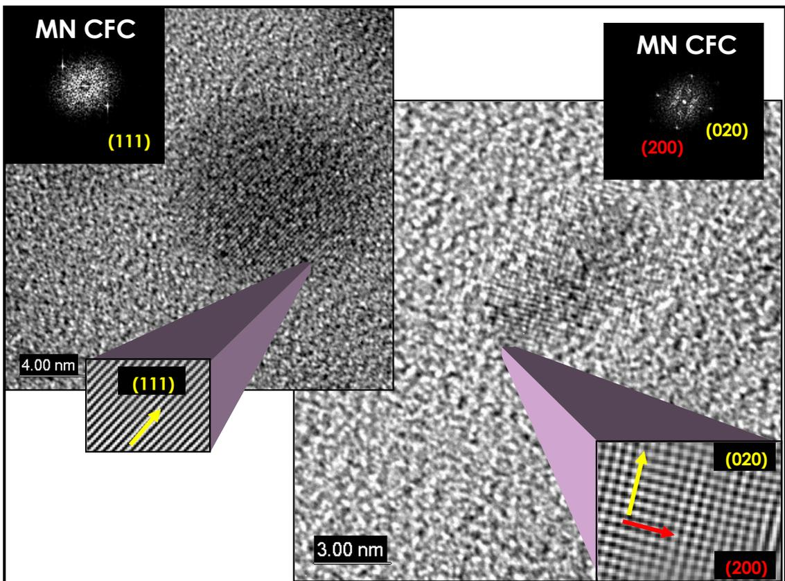
Figure II-34 : Réplique d'extraction de B3 nitruré (N6), effectuée à 50 $\mu$ m de la surface, observée au METHR - Nitrures MN CFC : images de haute résolution, transformées de Fourier, images filtrées dégagant les familles de plans  $\{111\}$  et  $\{200\}$  des nitrures.
