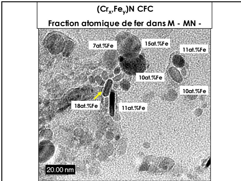
Figure II-47 : Réplique d'extraction de B3 nitruré puis diffusion d'azote (N6D3), effectuée à 50 $\mu$ m de la surface, observée au METHR - Vue générale de précipités avec les analyses EDX correspondantes.
