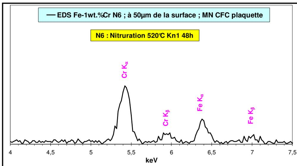
Figure II-30 : Réplique d'extraction de B1 nitruré (N6), effectuée à 50 $\mu$ m de la surface - Spectre EDX (diamètre de sonde  $\sim$  5nm), révélant la présence du fer et du chrome dans les nitrures ( $Cr_xFe_y$ )N CFC.
