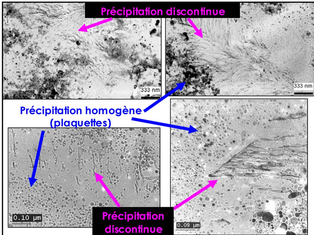
Figure II-31 : Réplique d'extraction de B3 nitruré (N6), effectuée à 50µm de la surface, observée au METHR - Vue générale de la précipitation homogène et de la précipitation discontinue germant à partir des joints de grains.
