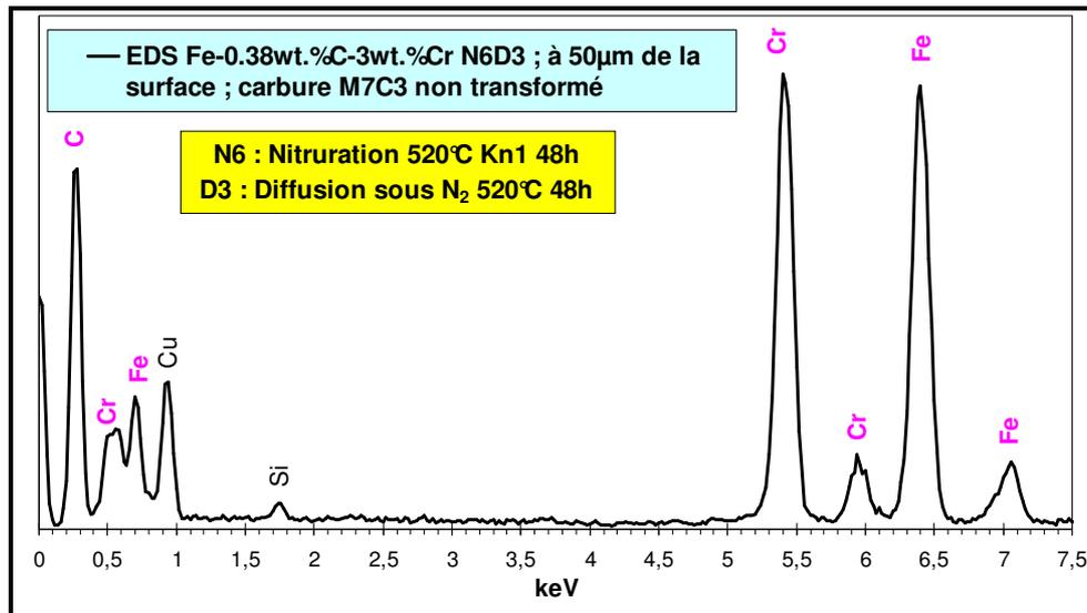
Figure II-65 : Réplique d'extraction de T3 après diffusion d'azote N6D3, effectuée à 50µm de la surface, observée au METHR - Les deux analyses EDX sur le carbure  $M_7C_3$  non transformé (Figure II-64) indiquent la présence de fer dans M. Il faut noter la présence du pic de carbone et aucun pic d'azote.
