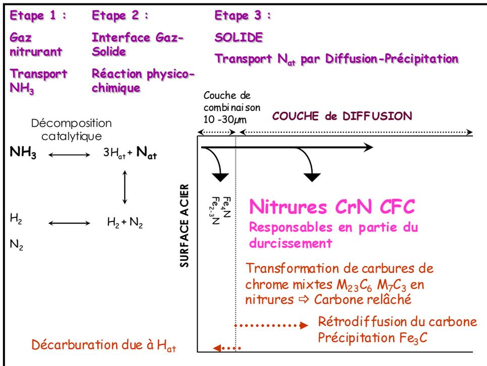
Figure I-2 : Schématisation de la réaction gaz-solide hétérogène, caractéristique du traitement thermo-chimique de nituration à la surface de l'acier, de la formation des deux couches niturées, ainsi que des phénomènes de précipitation associés.
