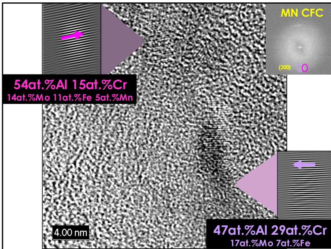
Figure III-33 : Réplique extractive, réalisée dans l'acier I nitruré (N1') à 50μm de la surface, observée au METHR - Plaquettes MN CFC : image de haute résolution, transformée de Fourier, image filtrée et spectre EDX.
