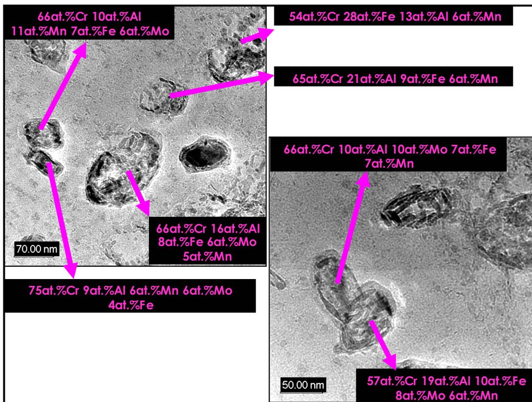
Figure III-29 : Réplique extractive, réalisée dans l'acier I nitruré (N1') à 50µm de la surface, observée au METHR - Nitrures globulaires incohérents : analyses EDX.
