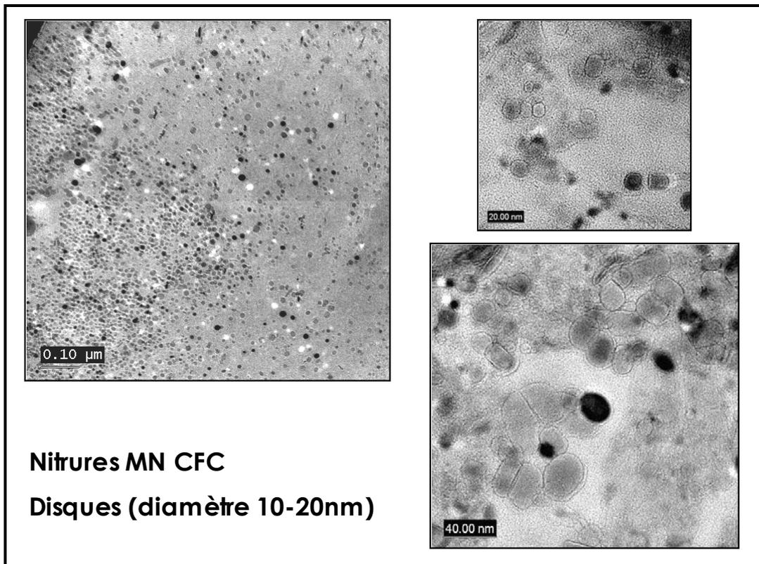
Figure II-32 : Réplique d'extraction de B3 nitruré (N6), effectuée à 50µm de la surface, observée au METHR - Vue générale de la précipitation homogène sous forme de plaquettes.
