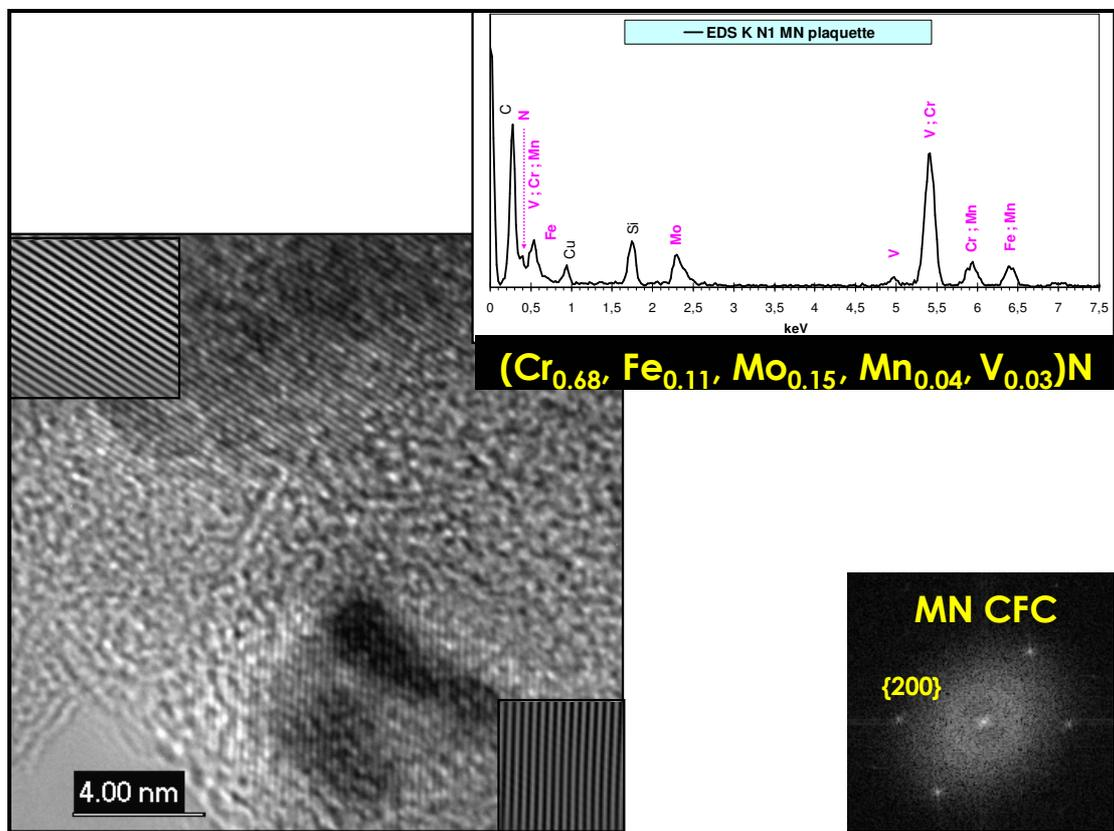
Figure III-19 : Réplique extractive, réalisée dans l'acier K nitruré (N1) à 50 $\mu$ m de la surface, observée au METHR - Nitrures MN : images de haute résolution, transformée de Fourier, images filtrées et spectre EDX.
