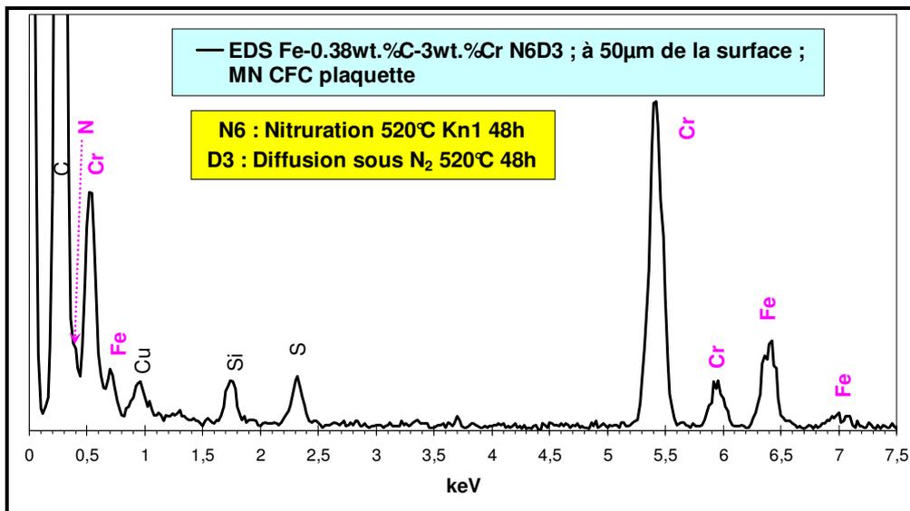
Figure II-58 : Réplique d'extraction de T3 après diffusion d'azote N6D3, effectuée à 50µm de la surface - Spectre EDX, réalisé au METHR.
