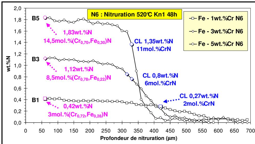
Figure II-22 : Profils N de B1, B3 et B5 nitrurés (N6) - Report des calculs thermodynamiques des phases, effectuées à 50μm de la surface et à PL (profondeur limite correspondant à CL pour le traitement de nitruration N6).
