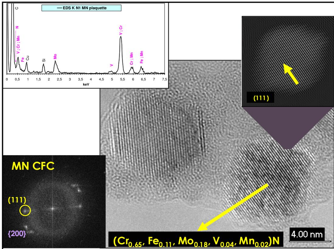
Figure III-18 : Réplique extractive, réalisée dans l'acier K nitruré (N1) à 50 $\mu$ m de la surface, observée au METHR - Nitrures MN : image de haute résolution, transformée de Fourier, image filtrée et spectre EDX. Les franges latérales sur le précipité de gauche sont le fait de la présence de l'oxyde Fe<sub>3</sub>O<sub>4</sub>.
