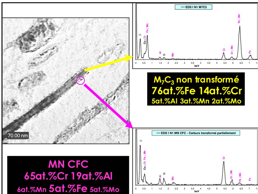
Figure III-23 : Réplique extractive, réalisée dans l'acier I nitruré (N1') à 50 $\mu$ m de la surface, observée au METHR - Transformation partielle de M<sub>7</sub>C<sub>3</sub> en nitrures MN globulaires : spectres EDX correspondant à chaque type de précipité.
