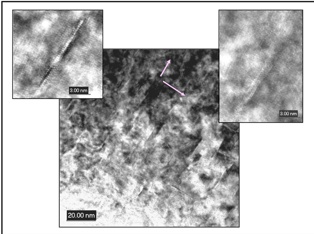
Figure II-52 : Lame mince provenant de T3 nitruré (N6), prélevée à 50 $\mu$ m de la surface, observée au METHR - Vue générale des précipités semi-cohérents (2 familles orthogonales sur les 3 sont présentes) avec agrandissements.
