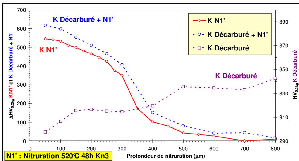
Figure III-15 : Profil de dureté de l'acier K décarburé (avant nitruration) - échelle de dureté à droite - ; Comparaison du profil de durcissement  $\Delta HV_{0,2kg}$  de l'acier K décarburé puis nitruré, avec celui de l'acier K nitruré, ayant subi un traitement thermique préalable usuel (austénitisation, trempe, revenu).
