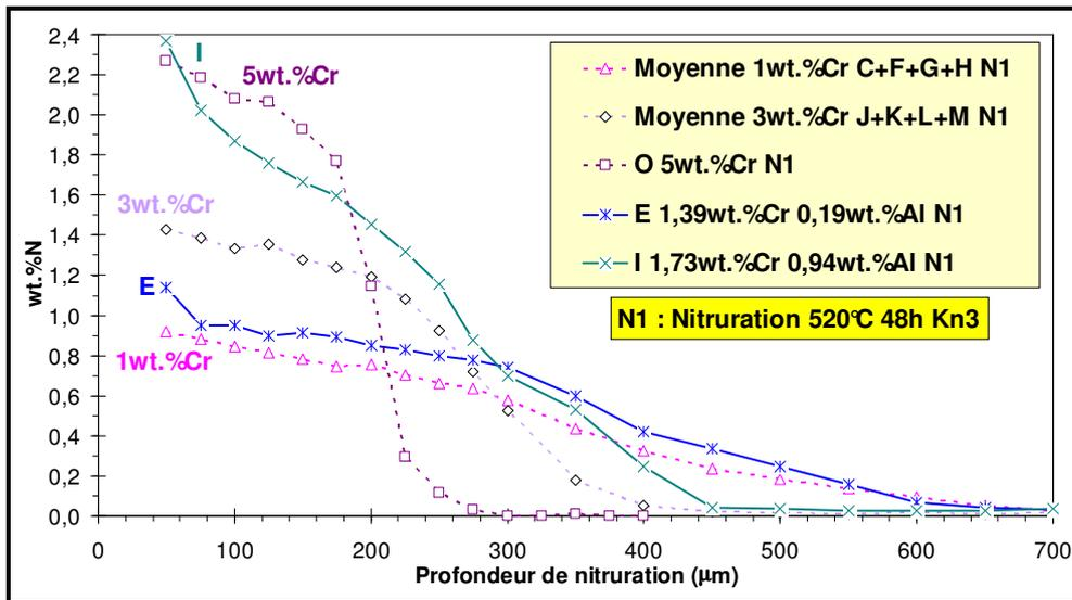
Figure I-26 : Profil N des aciers industriels nitrurés (N1).
