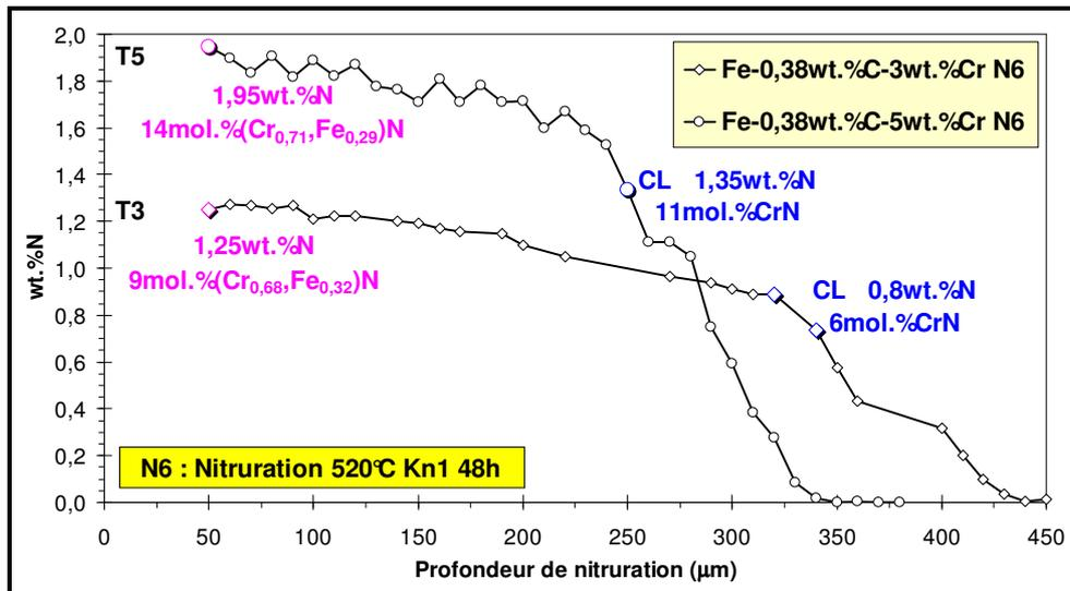
Figure II-23 : Profils N de T3 et T5 nitrurés (N6) - Report des calculs thermodynamiques des phases, effectuées à 50μm de la surface et à PL (profondeur limite correspondant à CL pour le traitement de nitruration N6).
