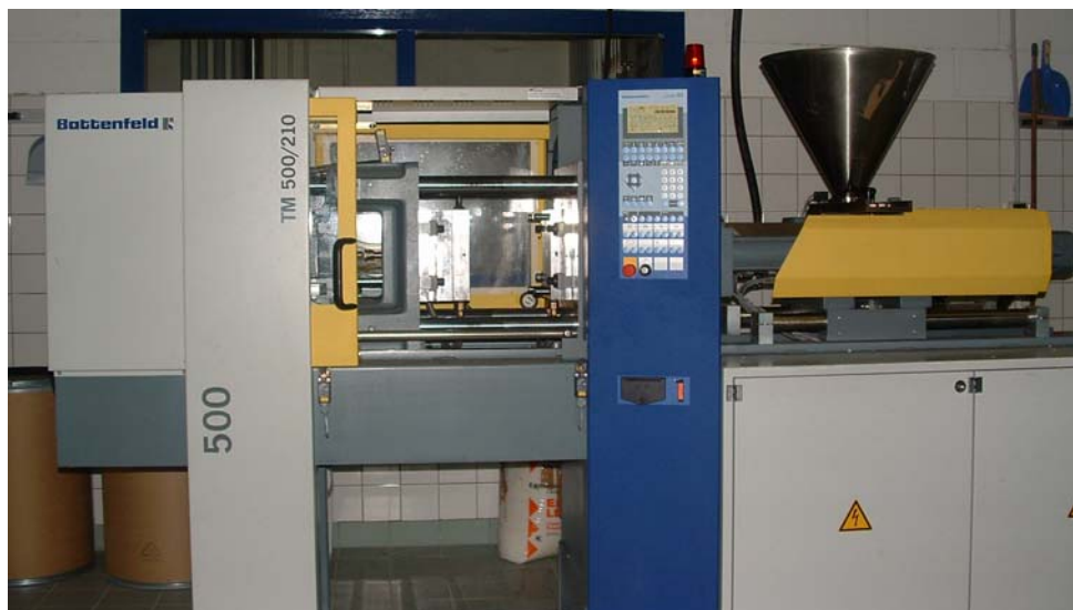
Figure 2.10 : Presse à injecter hydraulique Battenfeld.
