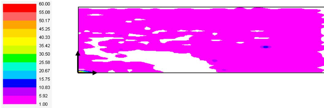
*Figure 1* : distribution de particules sur le plan de sortie lorsque les forces sont activés pour le cas où la coulée est sans sac de distribution.
