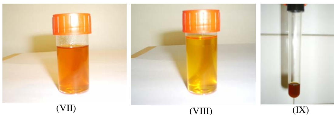
Figure 16. Huile totale des têtes de saumon extraite (VII) par solvant organique, (VIII) huile extraite par voie enzymatique, (IX) huile extraite des culots protéiques par solvants
