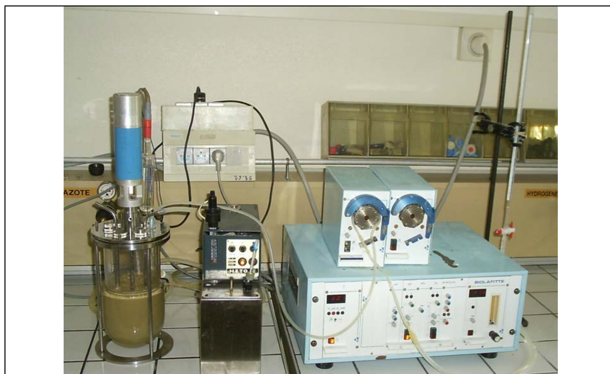
Figure 13. Dispositif de laboratoire (pH-Stat) d'hydrolyse des protéines de tête de saumon.
