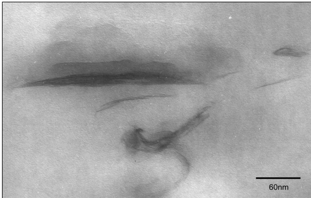
Figura 5.2.3: Micrografia da amostra AA1002- 5A5: a) agregados b) detalhe de uma região intercalada.
