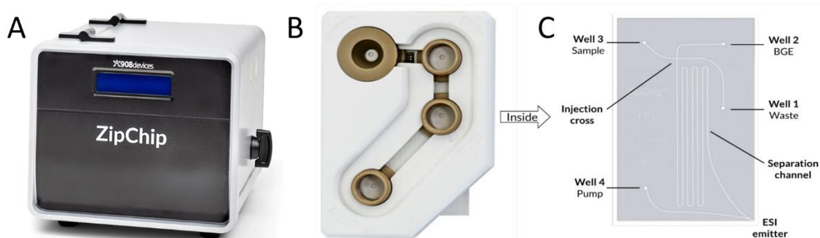
Figure 3.14 : Système CE-MS microfluidique « ZipChip » développé par 908devices avec (A) un module qui se positionne directement à l'entrée des spectromètres de masse et (B) la cartouche dans laquelle se glisse (C) la puce en verre où sont gravés les canaux microfluidiques (908devices). Extrait et adapté de [96].
