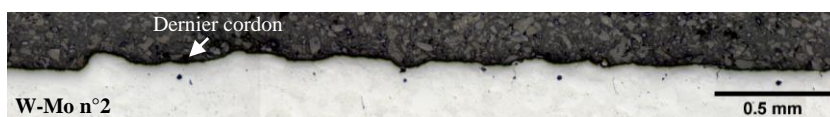
Figure 94 : cliché optique d'une coupe (normale au sens de balayage) d'un dépôt de 1 couche de W sur Mo
