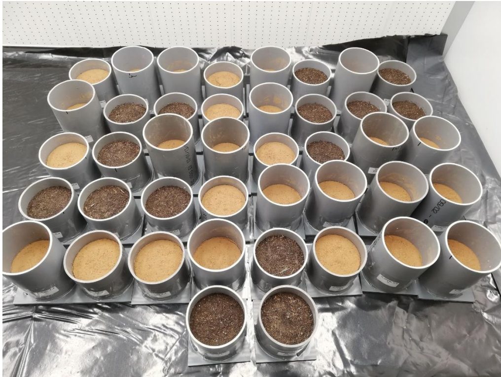
Figure 53 : Bloc de 42 dispositifs expérimentaux placés aléatoirement au sein de la chambre climatique
