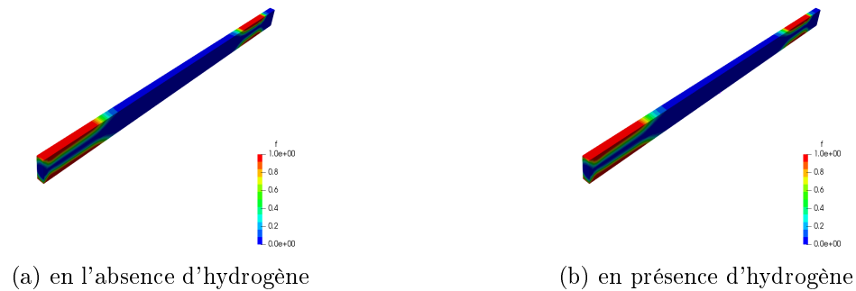
FIGURE 4.29 – Vue d'ensemble de la fraction de martensite dans le fil orthodontique.
