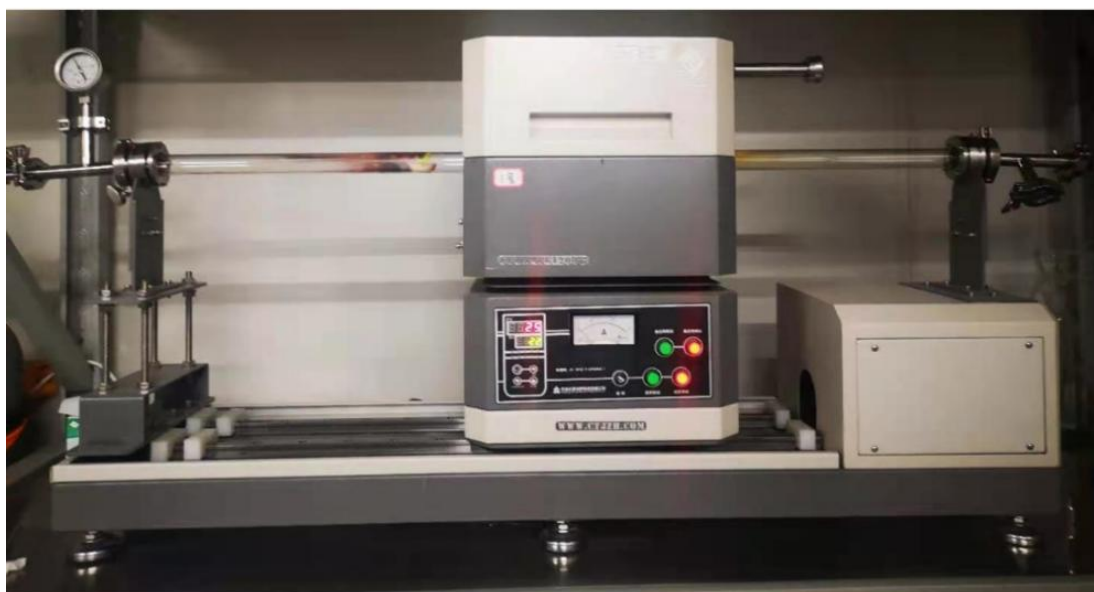
Figure R2.1. Four pour croissance CVD
