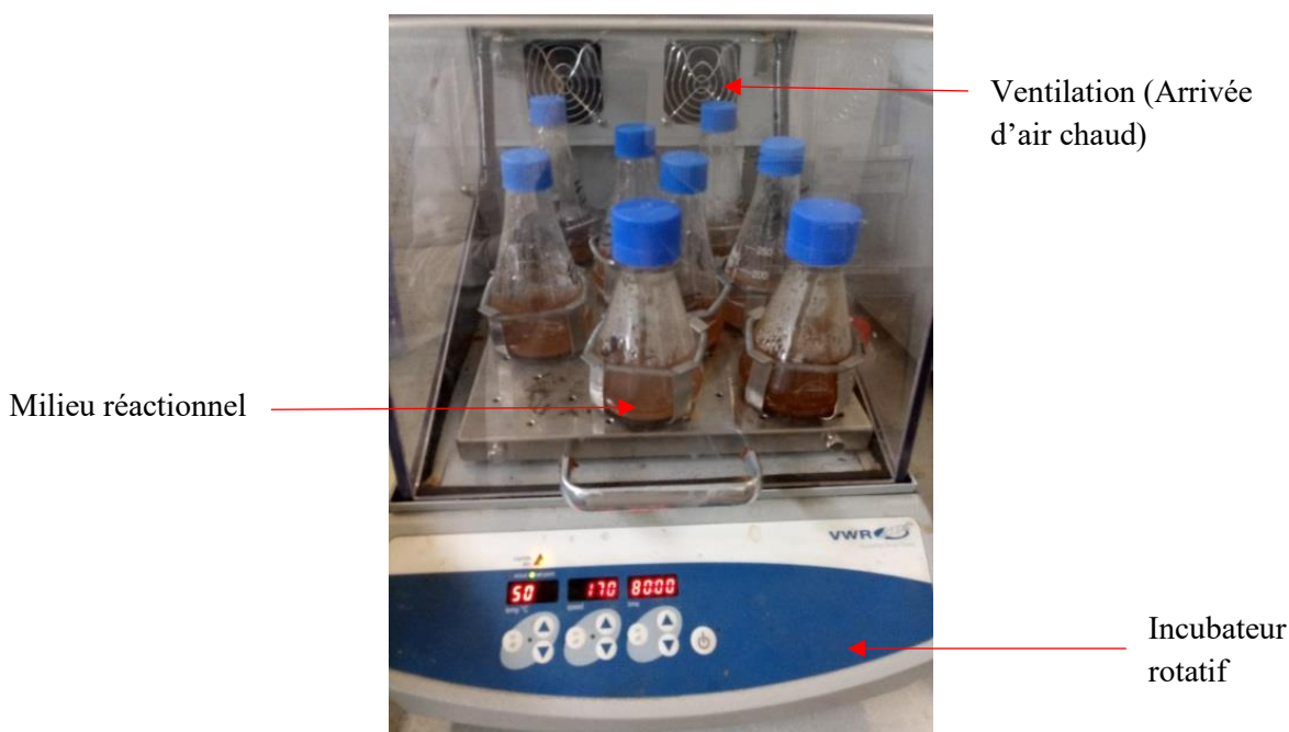
Figure 29: Dispositif expérimental utilisé pour la conduite des expériences d'hydrolyse enzymatique.
