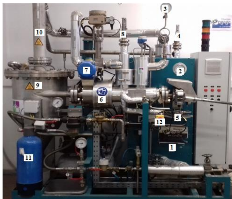
Figure 27: Installation pilote de l'explosion à la vapeur.
