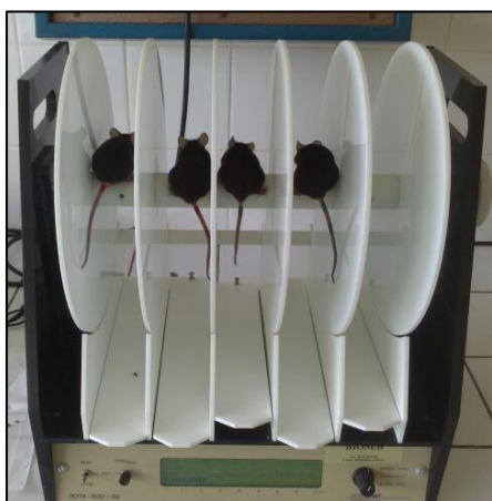
Figure 18 : Rotarod (Rota-Rod/RS Letica) utilisé dans l'étude. Cet appareil automatisé est formé d'une poutre rugueuse de 3 cm de diamètre actionnée par un rotor pour effectuer des rotations de vitesse déterminée. La poutre est cloisonnée de façon à permettre le travail de plusieurs souris dans un même temps. Lorsqu'elles chutent les souris tombent sur un levier qui arrête automatiquement le chronomètre individuel.
