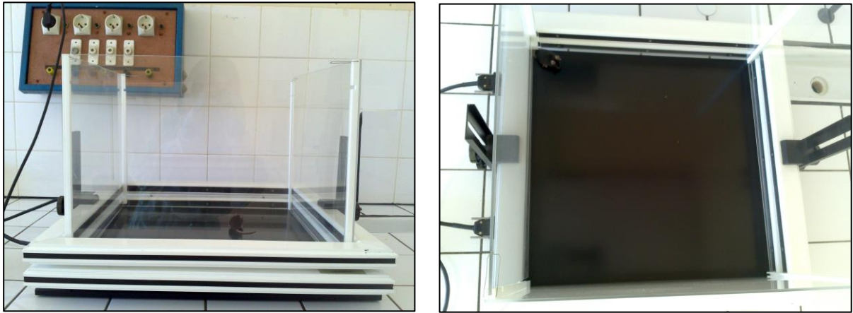
Figure 12 : Actimètre (Leticia, Modèle LE8811IR) utilisé pour l'étude. Formé par une enceinte de 45 x 45 cm avec un fond noir et des parois transparentes de 36 cm de hauteur. Les capteurs à infrarouge sont placés à deux hauteurs différentes.
