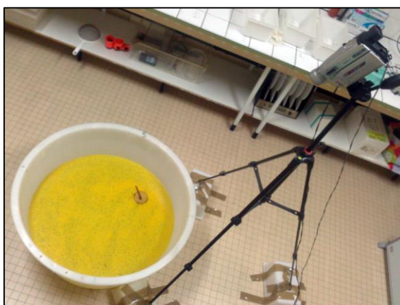
Figure 19 : Dispositif du test d'apprentissage visuo-spatial de la piscine de Morris utilisé pour l'étude. Le bassin circulaire a une hauteur de 30 cm, un diamètre de 86 cm, et est rempli d'eau tempérée à 21-22°C. Ici, la photographie montre le test de la plateforme visible dans lequel la plateforme (diamètre 12 cm) est positionnée au Sud-Est. Une caméra surplombant la piscine permet à l'observateur resté à distance d'observer sans perturber le parcours de la souris.
