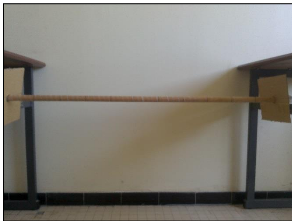
Figure 16 : Dispositif du test de la poutre. Ce dispositif placé à 70 cm du sol, se compose d'une barre cylindrique de 110 cm de long gradué tous les 10 cm (11 segments) et de 2.5 cm de diamètre. Afin d'améliorer l'agrippement des souris, un ruban adhésif rugueux recouvre la poutre. Un tapis de protection est rajouté au sol pour prévenir les blessures lors d'une chute.
