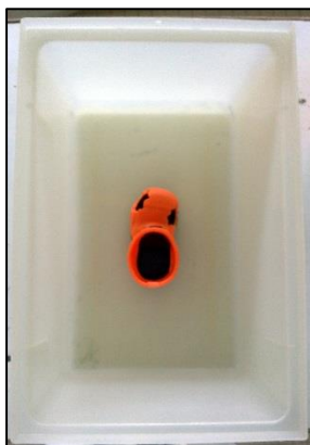
Figure 15: Dispositif pour le test d'émergence. Une petite enceinte est fixée au centre d'une enceinte rectangulaire de taille 41 cm x 27 cm et d'une hauteur de 18 cm. La petite enceinte a la forme d'une chaussure de couleur orange perforée de trois trous de différents diamètres et l'ouverture supérieure qui permettent à la souris de sortir dans la grande enceinte.
