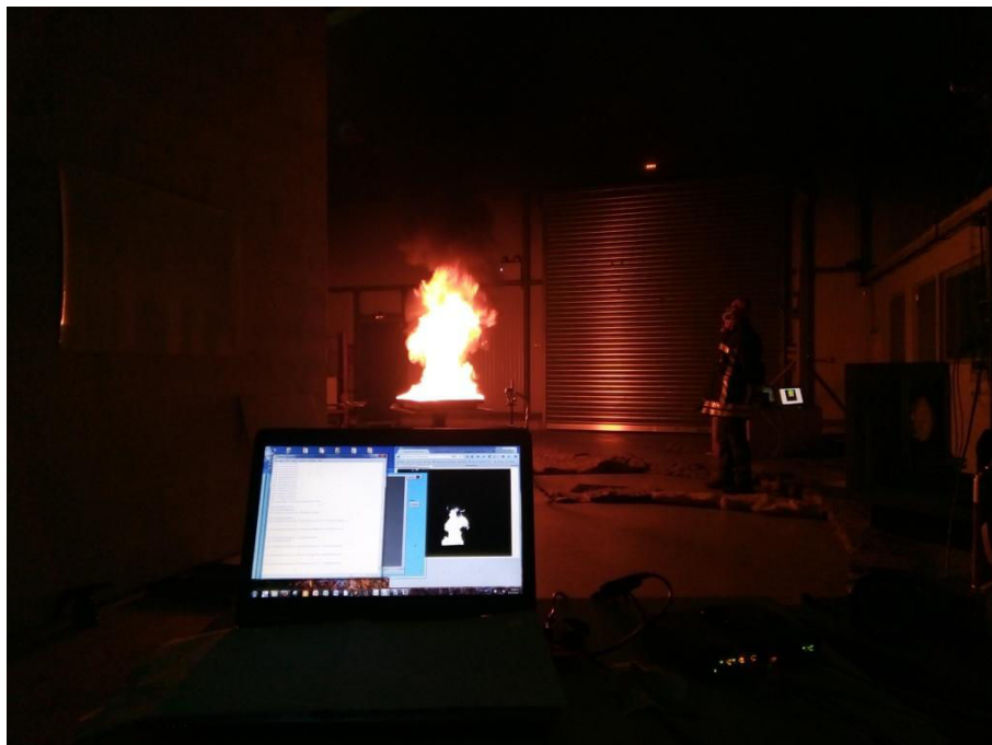
FIGURE 3.7 – Aperçu d'un essai kérosène de 0,5\text{ m}^2 à la Bouzule (PROMETHEI).
