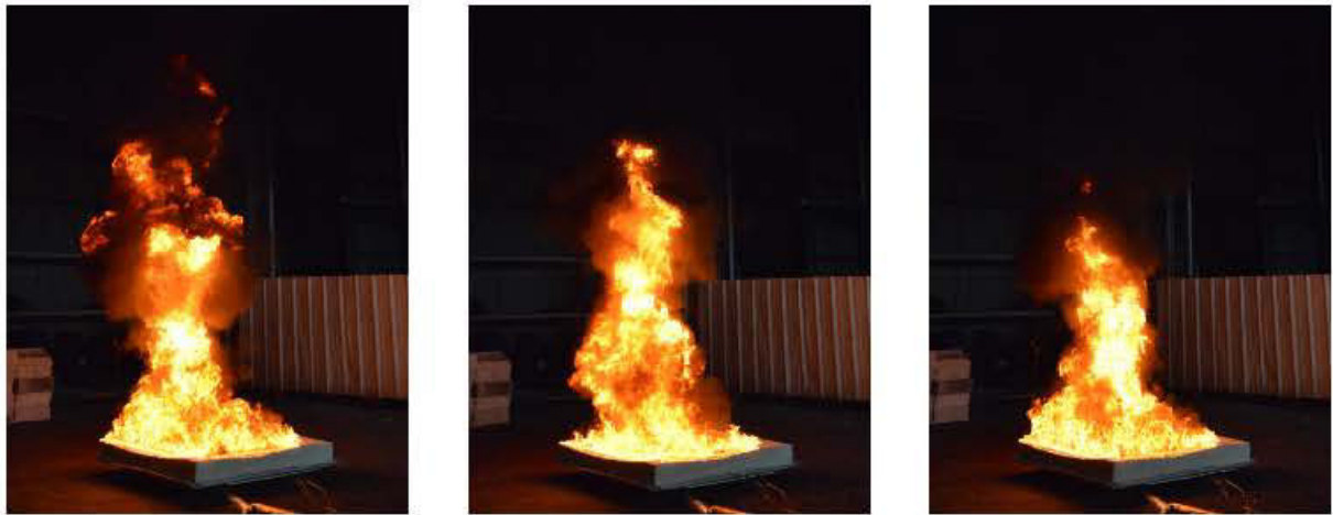
FIGURE 5.15 – Aperçu d’un essai mousse polyuréthane de 3\text{ m}^2 sur le site du CNPP.
