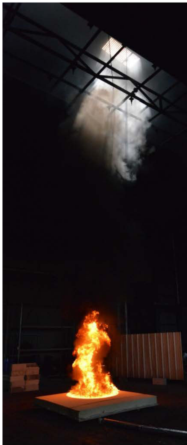
FIGURE 3.6 – Aperçu d'un essai mousse polyuréthane de 6 m 2 sur le site du CNPP.
