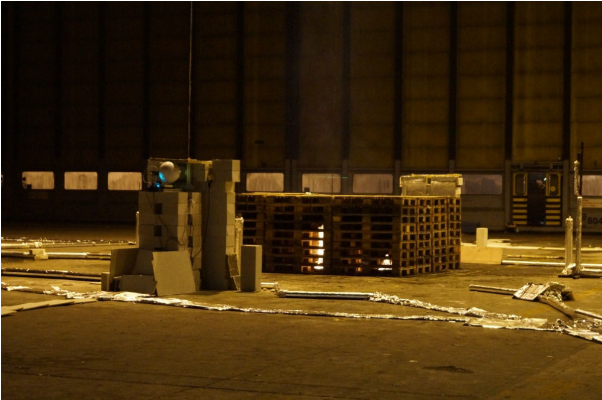
FIGURE 3.3 – Allumage d'un bûcher de 360 \times 320 \text{ m}^2 à ADP (photo CTICM).
