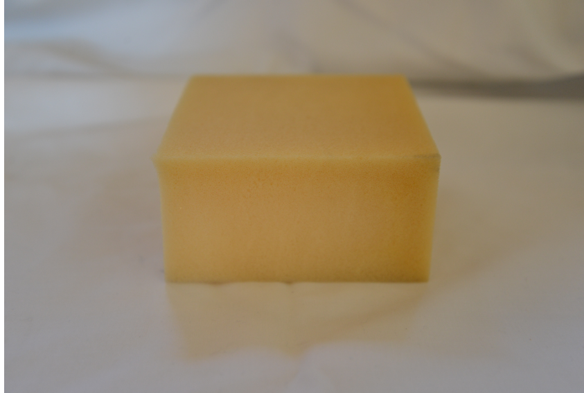
FIGURE 3.2 – Échantillon de mousse pour le cône calorimètre ( 10 \times 10 \times 5 \text{ cm}^3 ).
