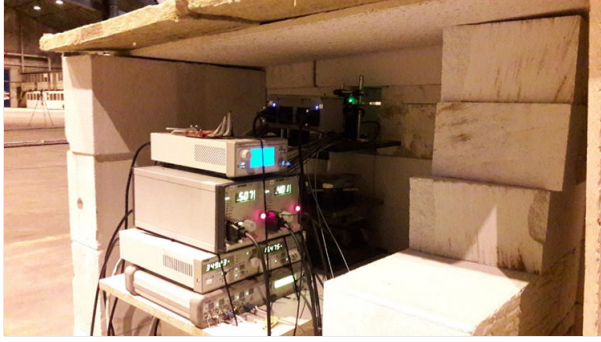
(a) Sources laser (le vert est visible sur une lame du hacheur).
