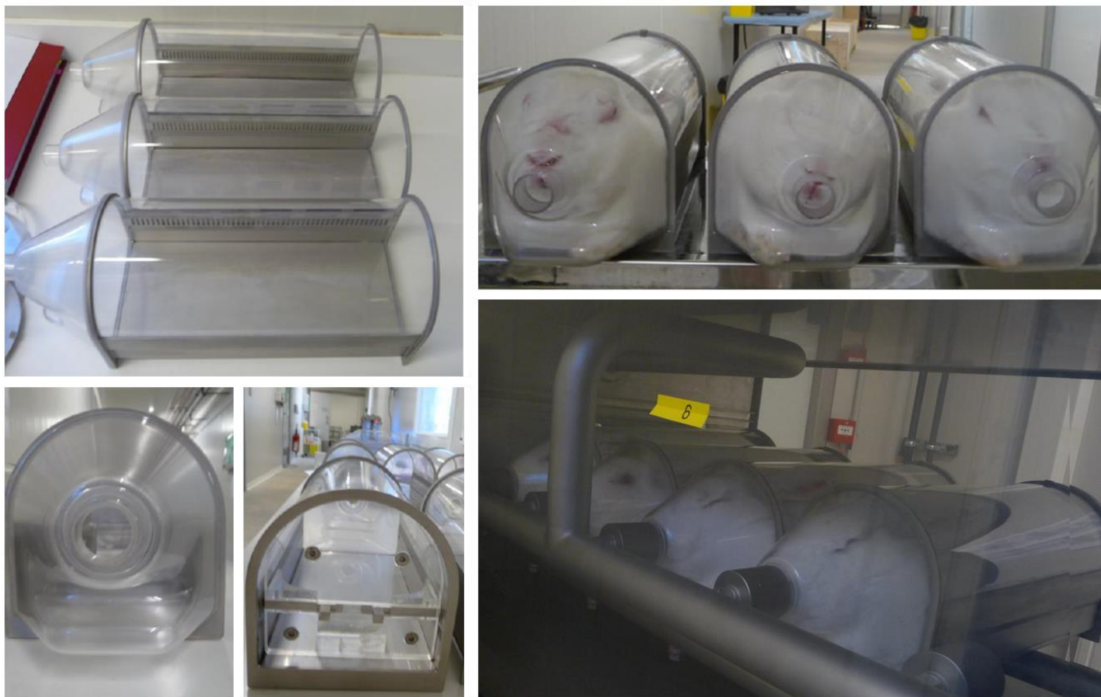
Annexe 3 : Dispositifs de contention mis en œuvre pour l'exposition par inhalation « nose only » chez la lapine gestante. A gauche sont présentés les tubes de contention, créés spécialement pour cette expérimentation. Ces derniers sont faits en plexiglas avec un fond en aluminium sous lequel un réservoir collecte les urines des lapines. Un morceau de plexiglas est placé à l'arrière du tube afin que la lapine ne puisse pas reculer pendant l'exposition. Enfin une plaque d'aluminium clôture la fermeture du tube. A droite sont présentées les lapines dans le tube de contention. On note l'ouverture à l'avant du tube au niveau duquel les animaux reçoivent le flux d'air (contaminé ou non-contaminé) au niveau du museau, grâce à un petit module d'exposition. Photos reprise du travail doctoral du Dr. Sarah Valentino ( Valentino et al, 2016b ).
