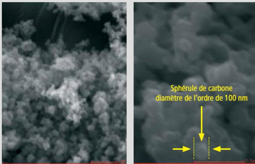
Micrographie électronique d'agglomérats et sphérules de carbone des particules diesel automobiles. Structure en agglomérat des particules issues d'un Moteur Diesel MDR 06 2045 (RVI). Source ESIM pour ADEME ( ADEME, 2005 )
