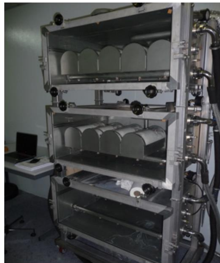
Annexe 4b : Dispositif d'exposition MAPCEL utilisé pour l'inhalation « nose only » des lapines gestantes. A gauche , est présenté l'extérieur du laboratoire mobile MAPCEL (Mobile Ambient Particle Concentrator Exposure Laboratory), utilisé pour la mise en exposition des lapines. L'exposition a été réalisée en collaboration avec l'équipe du Dr Flemming Cassee du National Institute for Public Health and the Environment (RIVM). A droite est présenté l'intérieur du laboratoire mobile MAPCEL. Le module d'exposition (évoqué en annexe 2) et relié à un moteur diesel 25KVA de l'entreprise Loxam, moteur de référence de l'équipe du RIVM. Photos présentées avec l'autorisation du Dr. Pascale Chavatte-Palmer (coordinatrice du programme ANR EPPAP).
