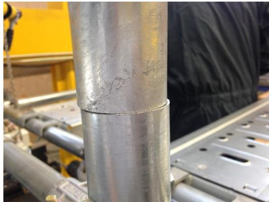
Fig. IV.25. Jeux d'assemblages maximales observés
