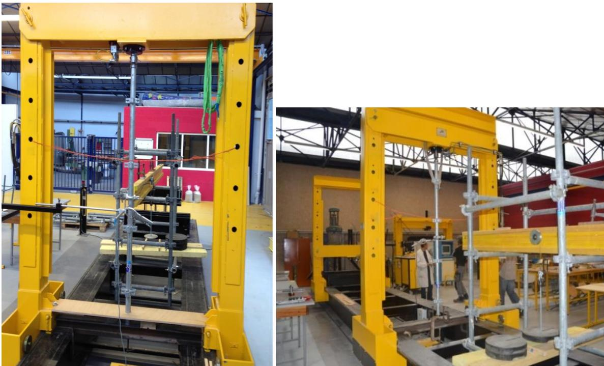
Fig. IV.1. Dispositif d'essai pour les barres simples
