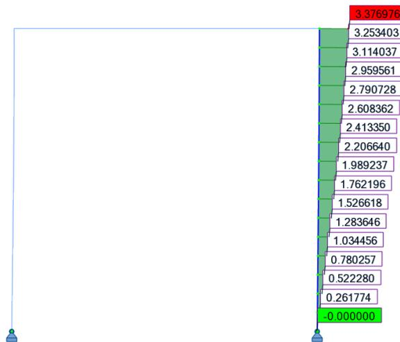
**Fig. IX.89.** Moment fléchissant au 2<sup>nd</sup> ordre du poteau droit avec ces propres imperfections
