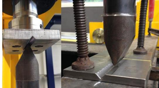
**Fig. IV.2.** Dispositif d'appuis : appuis tournevis
