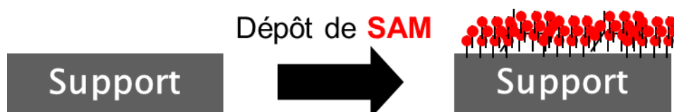
Figure 71: Une vue schématique du processus suivi pour obtenir les surfaces homogènes silanisées.
