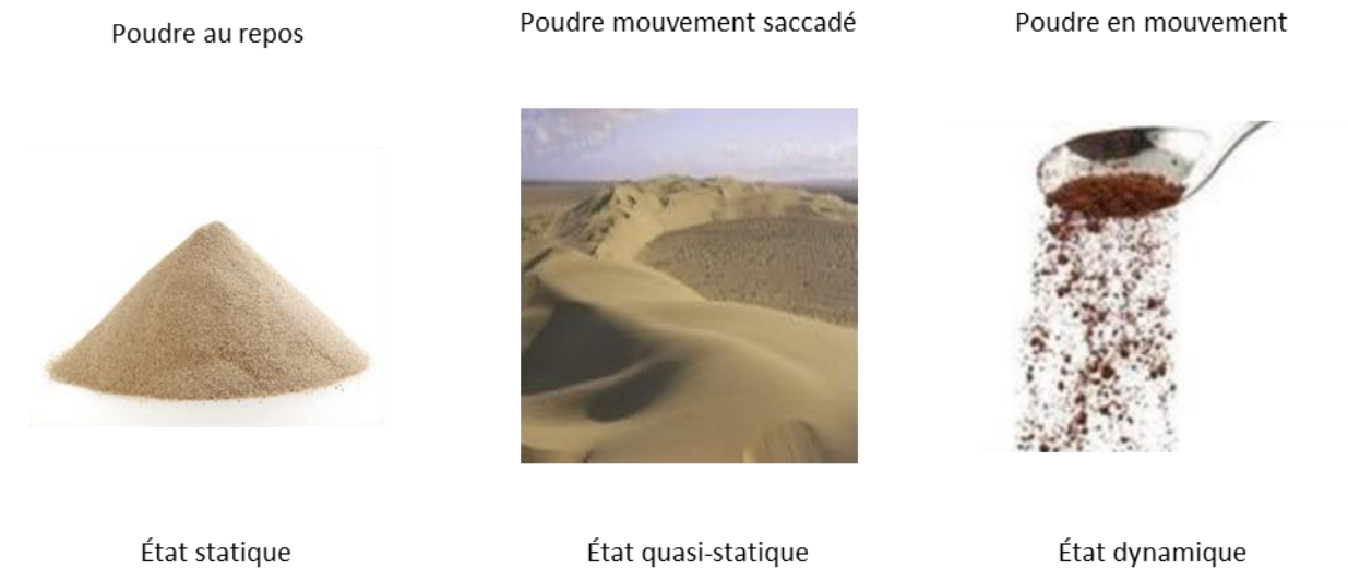
Figure I 3: Schéma de la classification des techniques d'écoulement proposée fondée sur l'état de la poudre
