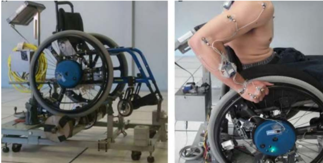
FIGURE 1.3 – Plateforme à base d’ergonometre[3]
