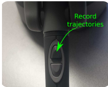
FIGURE A.1 – Présentation des boutons du Geomagic Touch.
