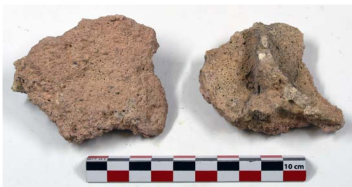
Fig. 15 – Joints beurrés de l'église de Vomécourt-sur-Madon (88). On remarque la prise entre deux pierres, qui montre que le mortier de pose n'est pas du tout saillant (cliché Cédric Moulis).
