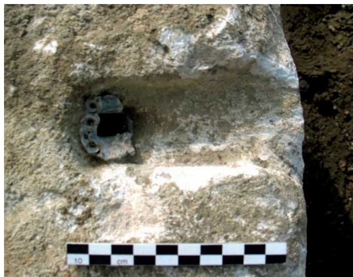
Fig. 9 – Traces de matage sur un plomb retrouvé avec une agrafe, pont de Dieulouard, 54 (cliché David Gucker - Inrap).
