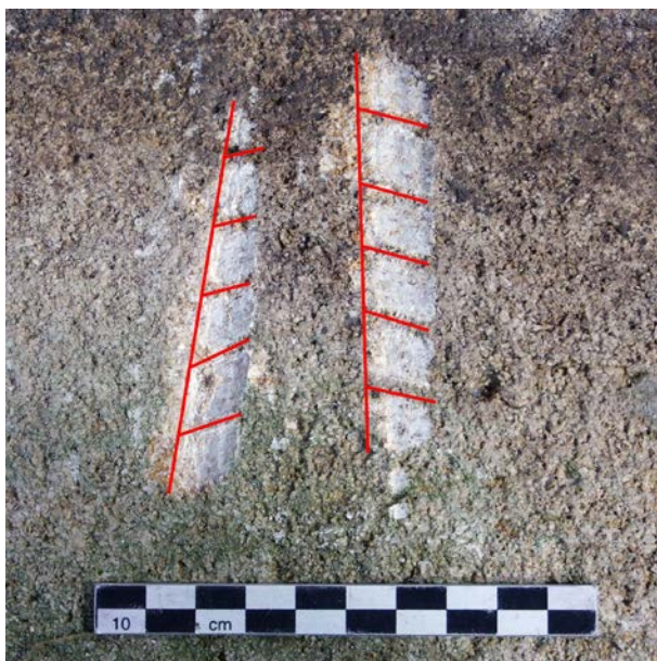
Fig. 40 – Trace laissée par une bretteuse manipulée par un gaucher (à gauche) et par un droitier (à droite). Les losanges formés présentent une orientation spécifique à la latéralité du tailleur (cliché Vianney Muller).
