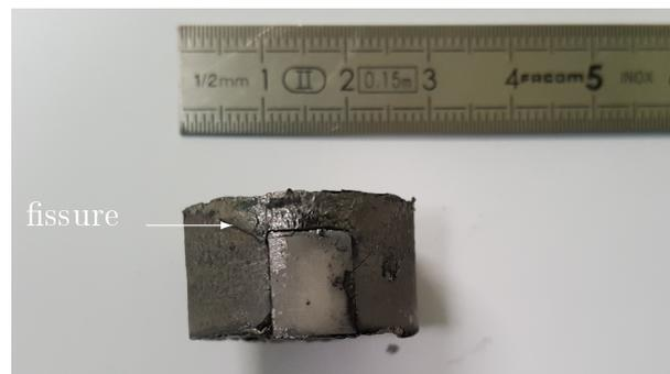
FIGURE V.12 – Macrographie d'un module thermoélectrique réalisé avec cale en alumine massive
