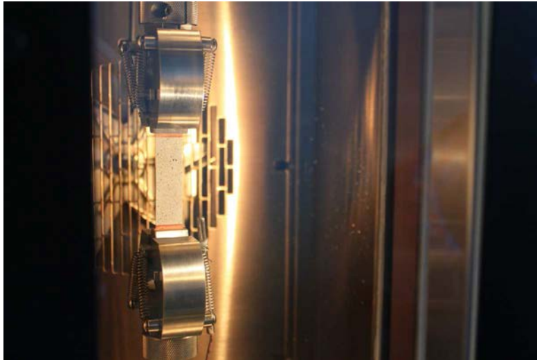
FIGURE 2.8 – Éprouvette en traction dans l’enceinte climatique.
