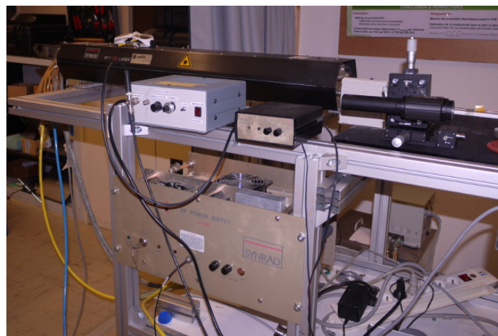
Fig. 7.3 Laser CO 2 continu de classe IV (130 W)
