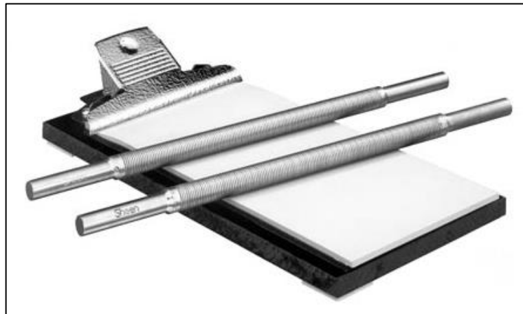
Figure II.4. Enduseur tire film « bar coater »
