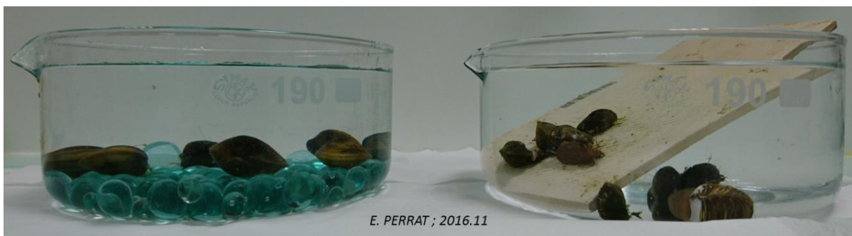
Figure 25 : Photo des dispositifs de maintien en milieu artificiel des bivalves en conditions contrôlées de laboratoire. A gauche C. fluminea maintenues en cristalliseur de 2L avec un fond en billes de verre ; A droite D. r. bugensis maintenues en cristalliseur de 2L fixées sur une plaque en céramique
