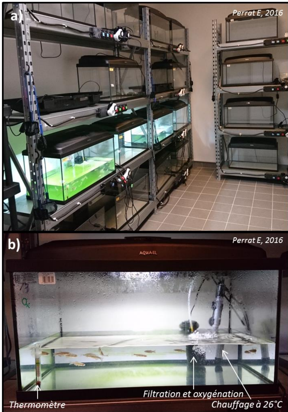
Figure 22 : Présentation de la partie de l'animalerie destinée au maintien des poissons zèbres a) Photo de la pièce d'élevage de poissons; b) Aquarium équipé contenant des Danio rerio femelles
