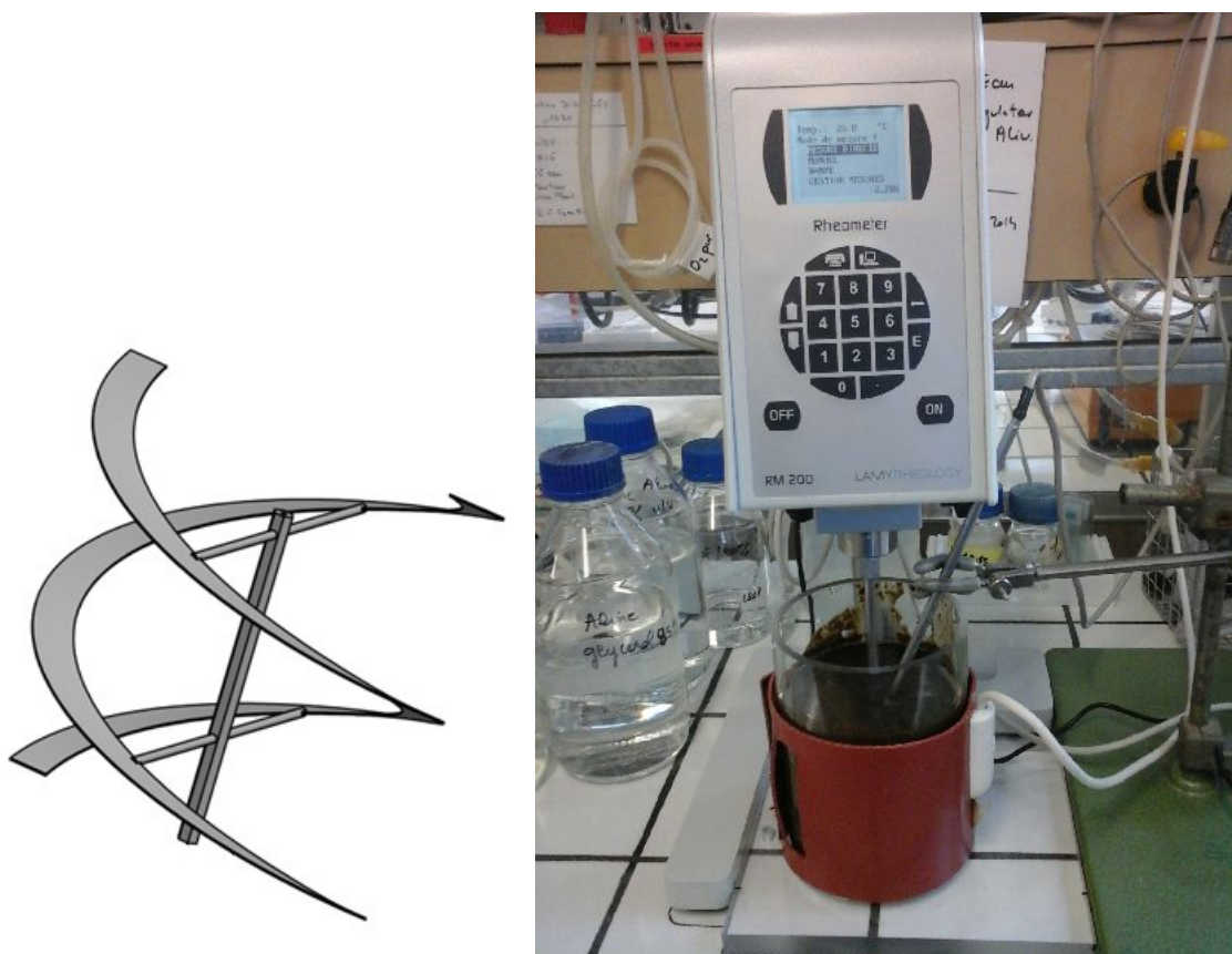
FIGURE 2.1 – Montage utilisé pour l'étude de rhéologie : Ruban hélicoïdal (à gauche) et montage avec viscosimètre (à droite).
