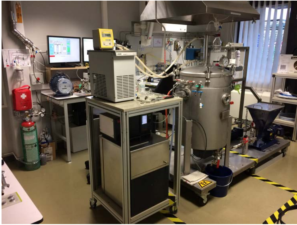
FIGURE 4.34 – Vue générale du réacteur pilote de 100 L et son instrumentation.
