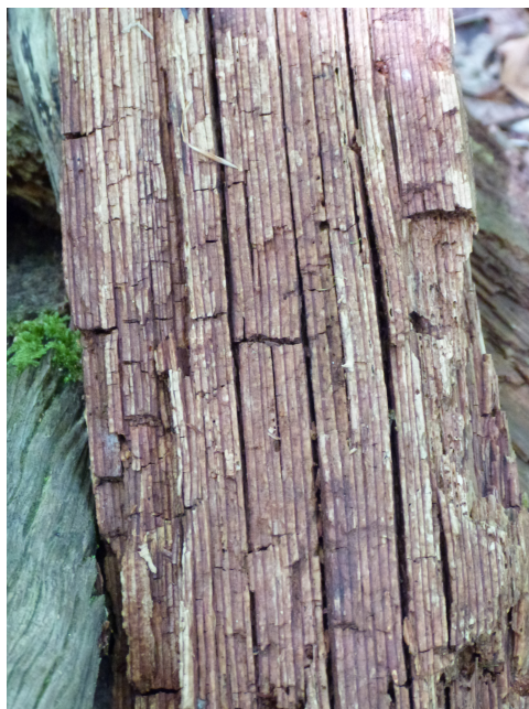
FIGURE 1.15 – Attaque de pourriture cubique sur une souche de bois en forêt
