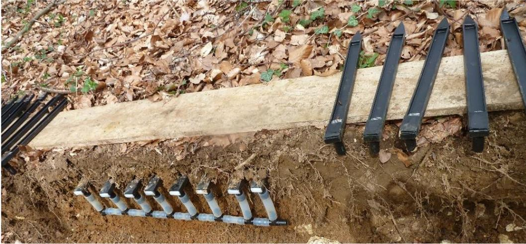
Figure 14 – Installation des flûteaux (lysimètres sans tension) dans une station expérimentale de Montiers.
