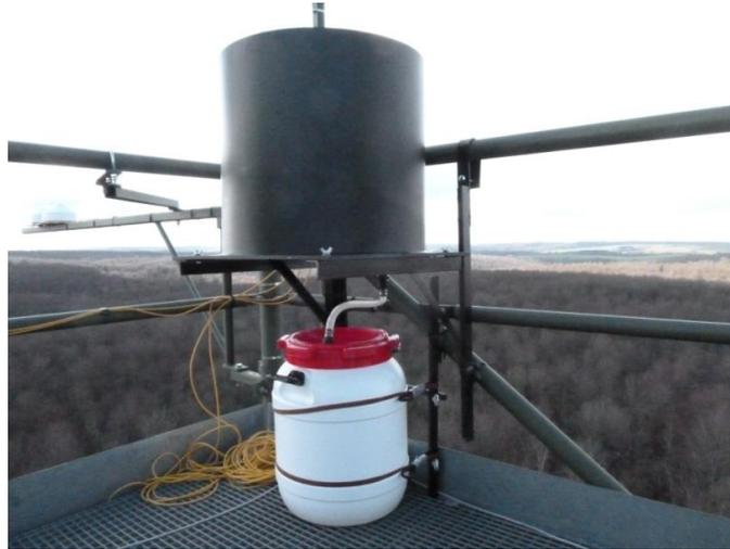
Photographie 5 – Capteur et bidon de collecte des dépôts atmosphériques sur la tour à flux de Montiers.
