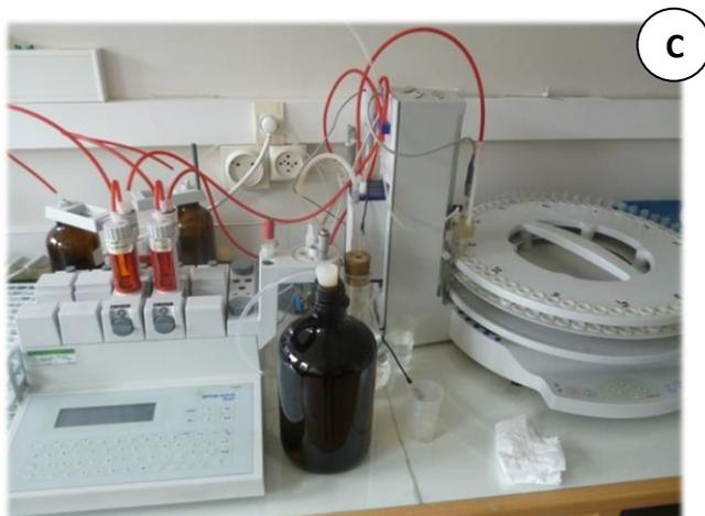
**C** - Le pH est mesuré avec un pH-mètre (DL70 ES de METTLER) équipé d'une électrode en verre.
