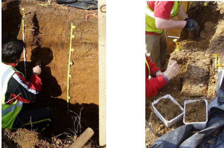
Photographie 11 – Description d'un profil de sol (à gauche) et prélèvement d'horizons de sol (à droite) dans une fosse de réception du site expérimental de Montiers.
