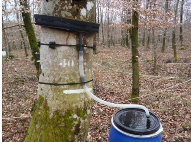
Photographie 7 – Dispositif de récolte des écoulements de tronc.
