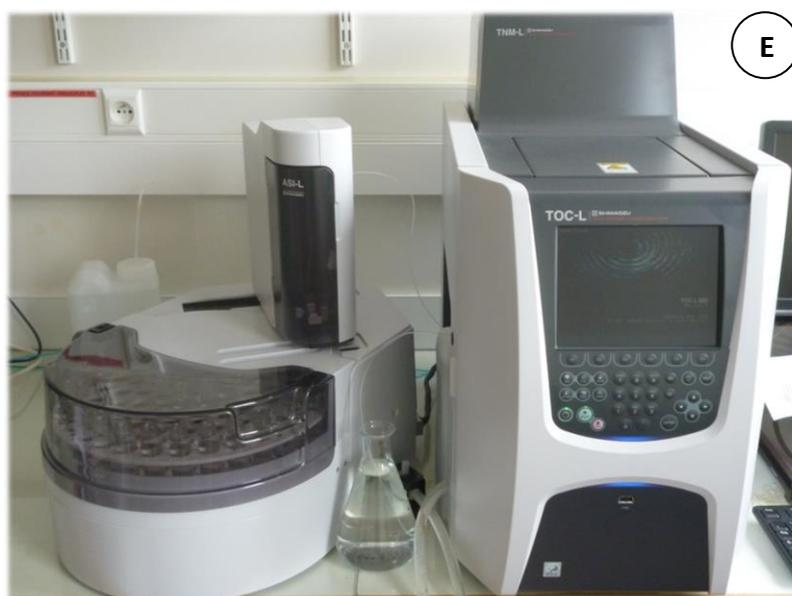
**E** - Le carbone organique dissous (COD), le carbone total et l'azote total sont quantifiés par un analyseur de carbone organique total (TOC-L de SHIMADZU). Le principe se base sur une combustion catalytique à 680°C. Cette méthode permet une oxydation complète et rapide de tous les composés organiques de l'échantillon.
