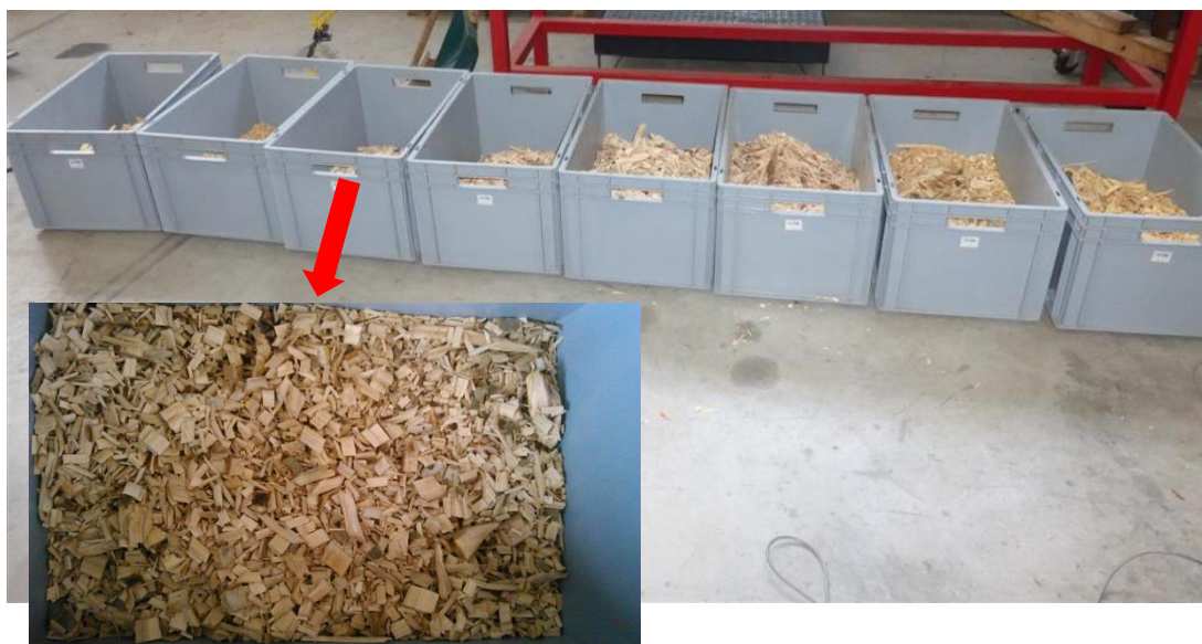
Figure 30 : Plaquettes récupérées lors du déchiquetage de 8 rondins
