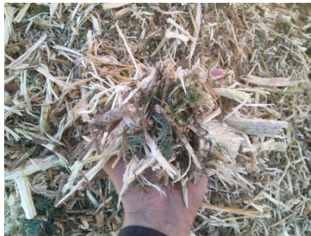
Figure 1 : Fibres de bois obtenues par défibrage (Source : SL)
