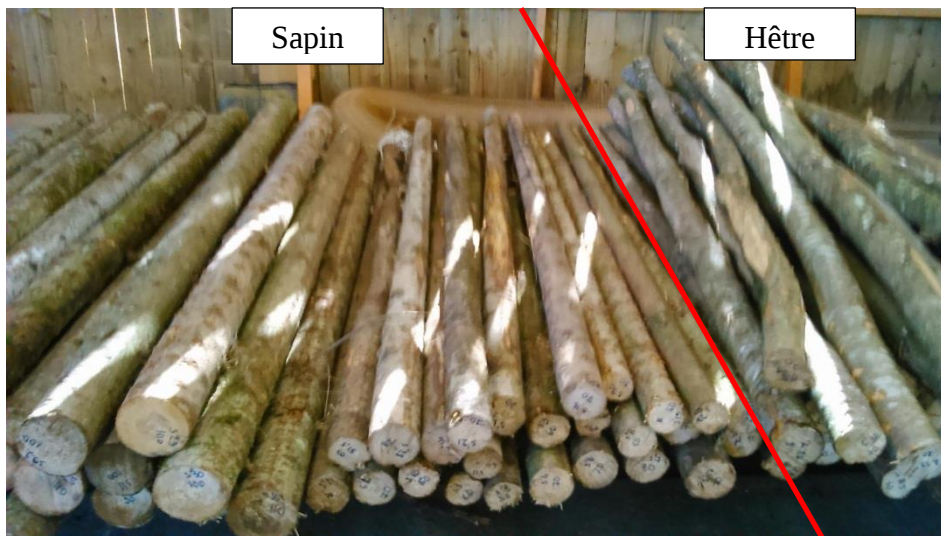
Figure 29 : Rondins utilisés pour les essais de déchiquetage : à gauche du trait : Le sapin, à droite du trait : Le hêtre
