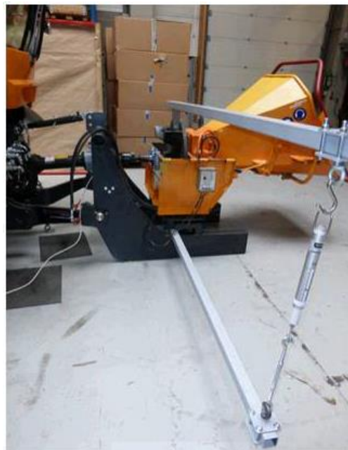
Figure 90 : Dispositif d'étalonnage du cardan instrumenté
