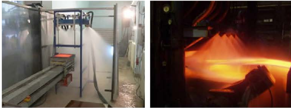
Figure 2 – Refroidissement par sprays de brames d’acier défilantes
