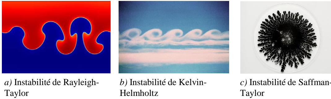
Figure 5.41 – Illustrations des différentes instabilités étudiées comme origines potentielles de la digitation.
