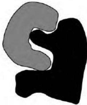
Figure 11: Exemple de liaisons d'emboitement entre les particules (D'après Janwong (2012))
