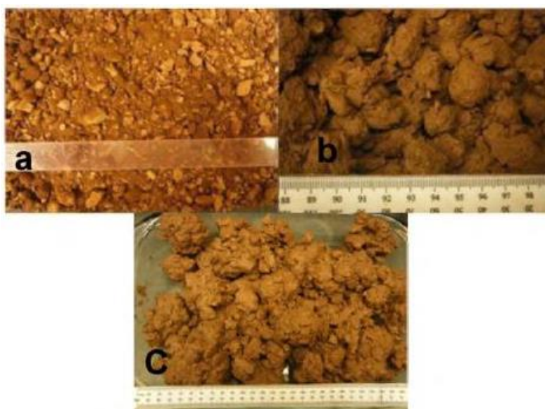
Figure 16: Photos d'agglomérats a) Trop sec (humidité de 10% et concentration d'acide 1840g/l) b) Bonne qualité (humidité de 20% et concentration d'acide 102g/l) c) Trop humides (humidité de 25.6% et concentration d'acide 102g/l) (d'après Janwong (2012))
