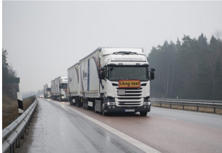
FIGURE 1.2 – Trois camions Scania ont été conduits de Sodertalje, en Suède, à Rotterdam, aux Pays-Bas, au cours du défi européen de commande de convoi
