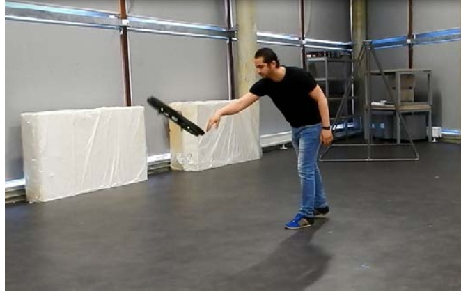
FIGURE 4.8 – Un opérateur pousse un UAV et génère une perturbation.
