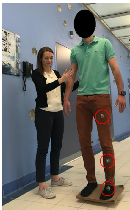
Figure 10 : Analyse cinématique à l'aide de capteurs de mouvement (BioVal, RM Ingénierie, Rodez, France).
