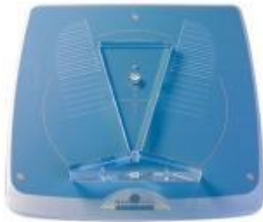
Figure 7 : Posturographie. Plateforme de forces verticales (Win-Posturo, Medicauteurs, Balma, France) ( www.medicapteurs.fr ).
