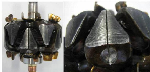
Figure 1.30 : Insertion d'une fente dans les griffes du rotor de l'alternateur [20]
