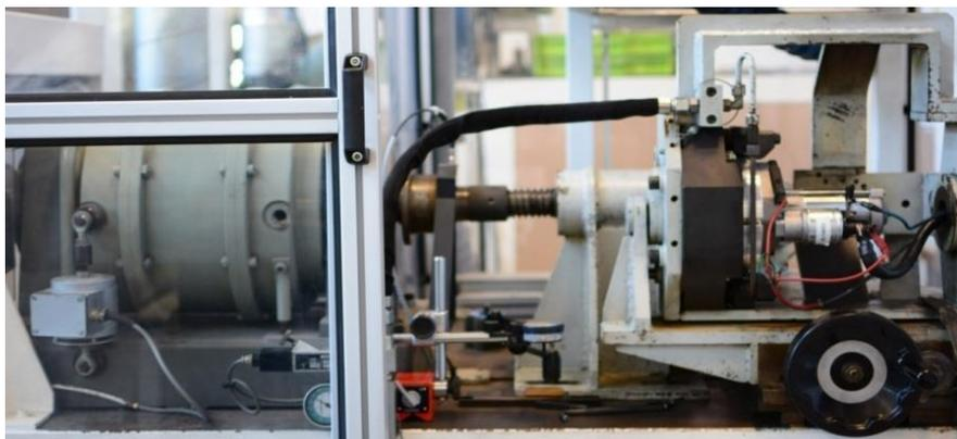
Figure 3.49 : Banc de mesure du couple, de la vitesse, et de puissance des démarreurs
