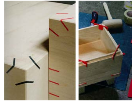
Figure 2.13 - Assemblage par clavettes. Laetitia Florin, École Cantonale d'Art de Lausanne (ECAL). D'après (Glasner, Ott, 2013).
