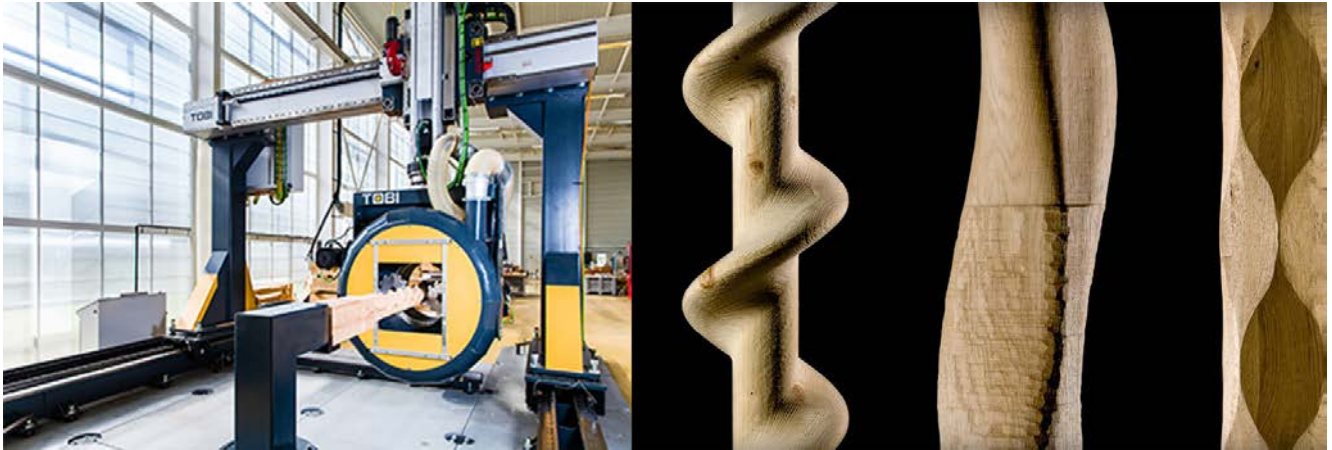
Figure A2.17 - Procédé «TOBI» (Tour à Bois Innovant) permettant un fraisage épicycloïdal multidirectionnel. Société d'Innovation et d'Ingénierie en Machines-Outils (SIIMO).
