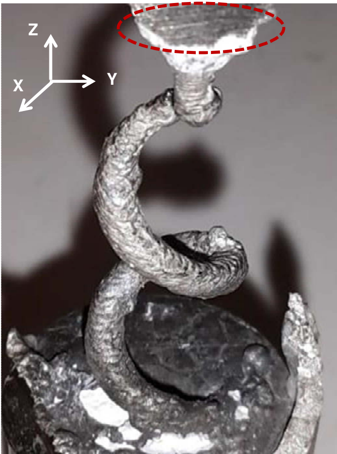
Figure D-5: Spirale après solidification dirigée et retrait mécanique de l'alumine frittée
