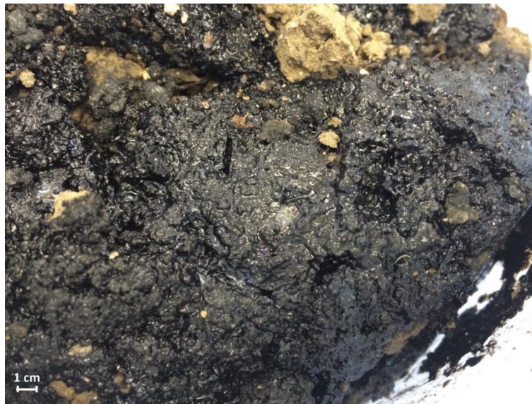
Figure 20 : Goudron de houille de l'ancienne usine à gaz de Pontoise
