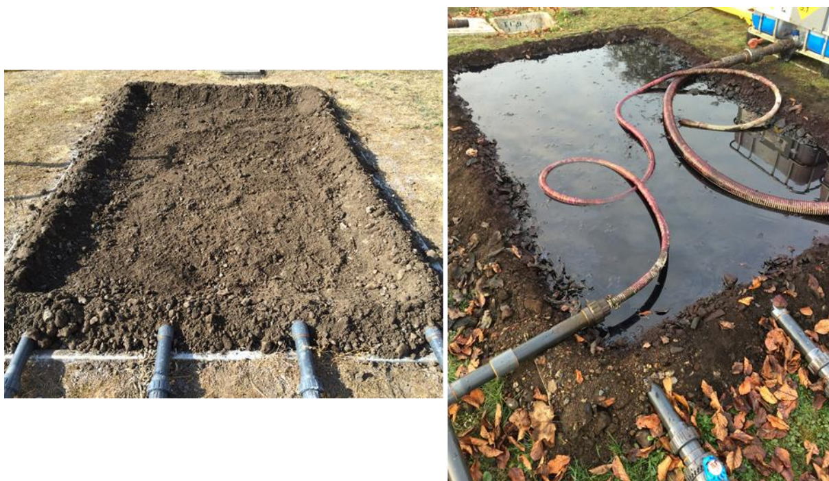
Figure 55 : Mise en place de berges de terre (à gauche) pour contenir l'oxydant lors du noyage partiel des parcelles lysimétriques (à droite)
