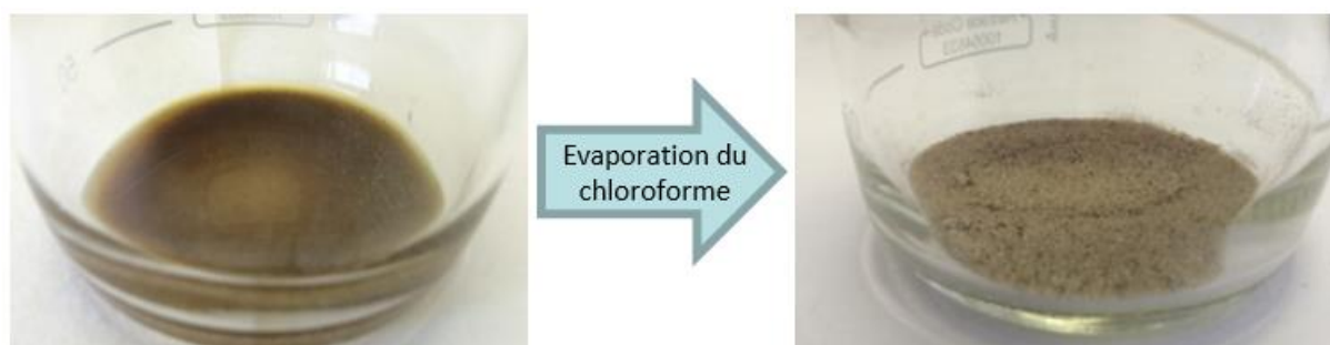
Figure 75 : Dopage du sable de Fontainebleau avec une solution-mère de goudron de houille
