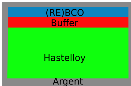
Figure 4.5 Illustration de l'architecture d'un ruban supraconducteur de Superpower Inc. (Pas de mise à l'échelle).
