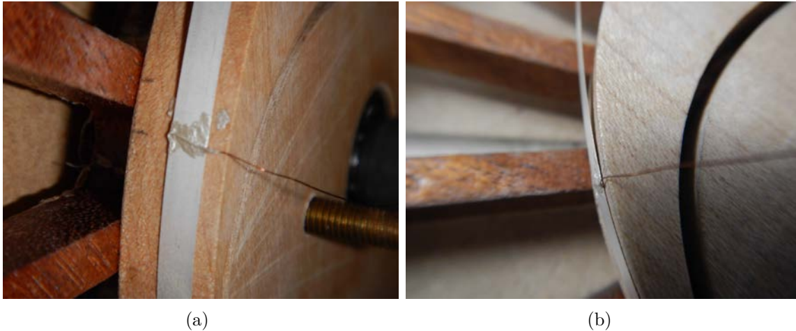
Figure 5.11 Photographies illustrant la mise en place des prises de mesure du potentiel électrique à l’aide d’un fin fil de cuivre et de peinture d’argent.
