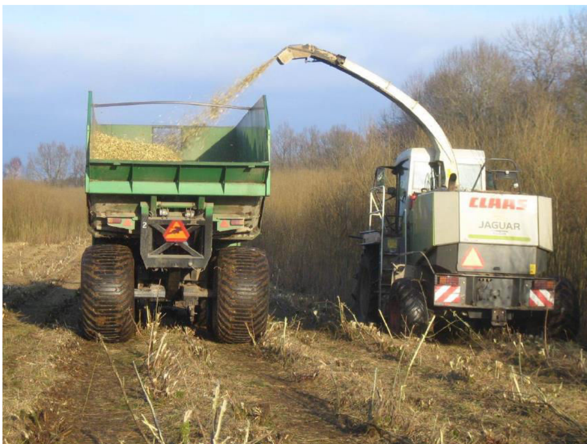
Figure 33 : Récolte et broyage de biomasse ligneuse en TTCR avec une ensileuse équipée d'une tête de récolte adaptée (image de Dimitriou I. (Dimitriou et Rutz, 2015))
